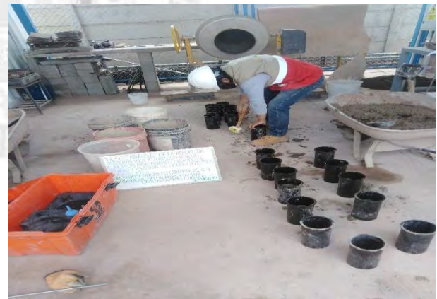
Moldeo de las briquetas del concreto (CC) (4"x8")
