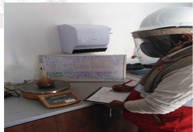
Pesado de fiola + muestra + agua del Agregado fino de Supermix. VACIADO DEL CONCRETO PATRON (CC)
