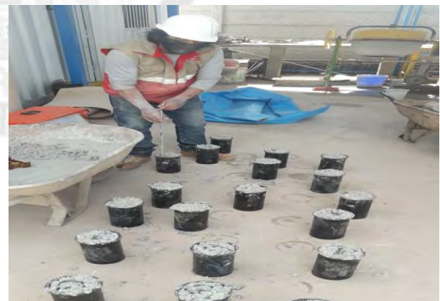
Moldeo de las briquetas del concreto (EHE 75%, TIO2 5%) (4"x8") VACIADO DEL CONCRETO CON EHE 75% Y TIO2 7.5%
