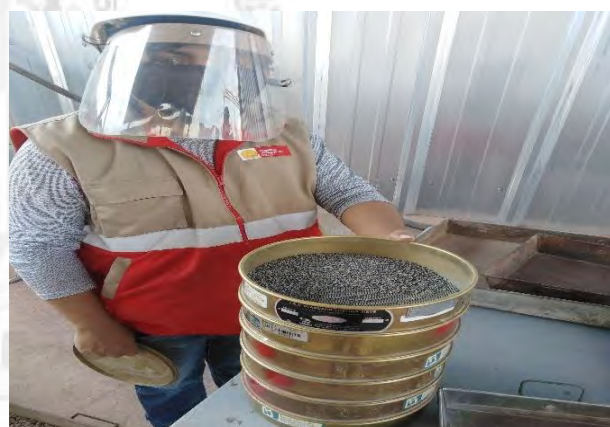
Tamizado de agregado fino de Escoria de hornos ELÉCTRICOS.
