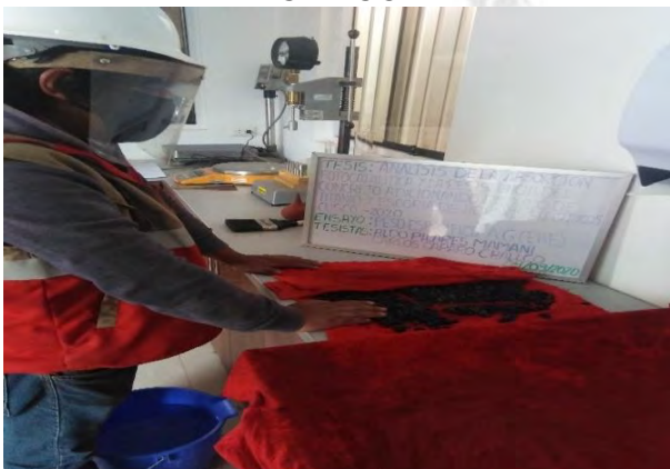
Secado con franela para Peso Especifico y Absorción de Agregado grueso de Escoria de hornos ELÉCTRICOS.
