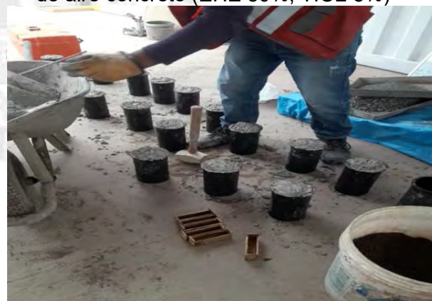
Moldeo de las briquetas del concreto (EHE 50%, TIO2 5%) (4"x8")
