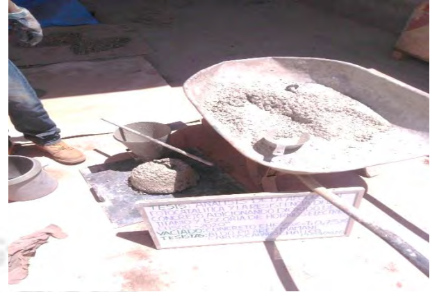
Control e temperatura del concreto (EHE 75%, TIO2 7.5%)
