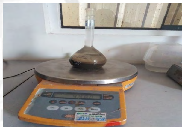
Pesado de fiola + muestra + agua del Agregado fino de Escoria de hornos ELÉCTRICOS.
