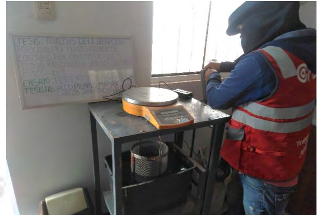
Pesado en canastilla sumergida para ensayo Peso específico y Absorción de Agregado grueso de Escoria de hornos ELÉCTRICOS.
