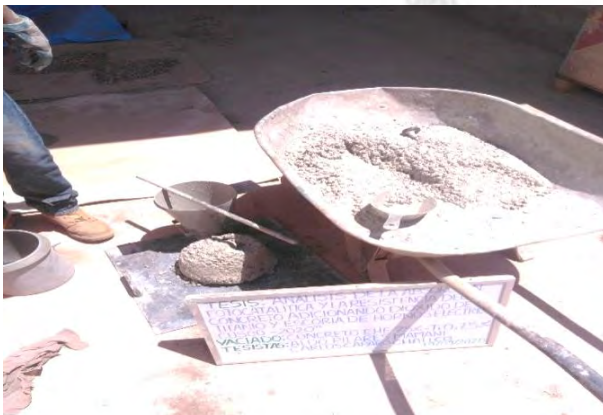
Determinación de Asentamiento del concreto de (EHE 75%, TIO2 7.5%)
