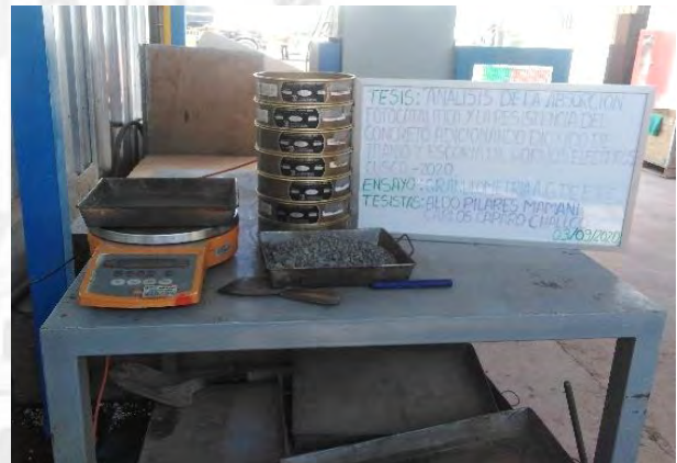
Tamizado para granulometria de Agregado grueso de Escoria de hornos ELÉCTRICOS.
