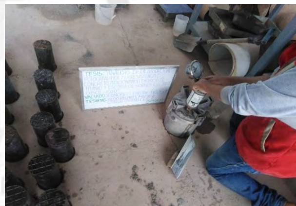
Olla Washington, medición de contenido de aire concreto (EHE 50%, TIO2 5%)
