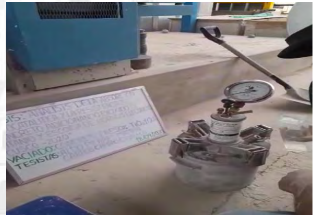
Olla Washington, medición de contenido de aire concreto (EHE 50%, TIO2 10%)
