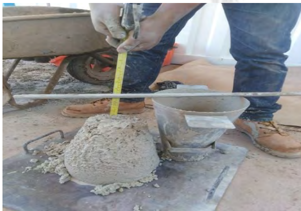
Determinación de Asentamiento del concreto de (EHE 75%, TIO2 5%)
