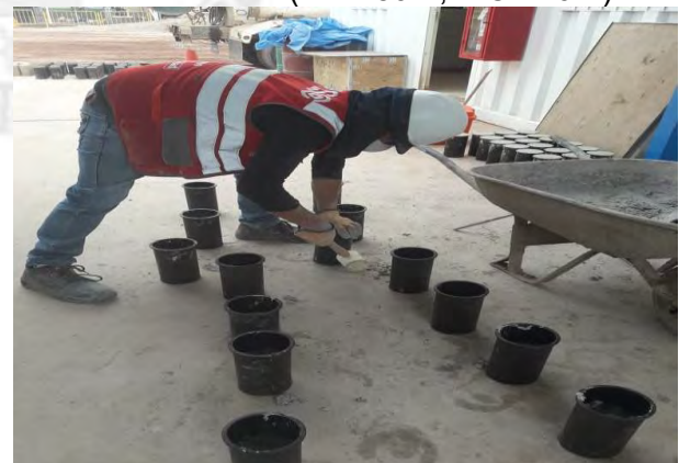
Moldeo de las briquetas del concreto (EHE 50%, TIO2 10%) (4"x8")
