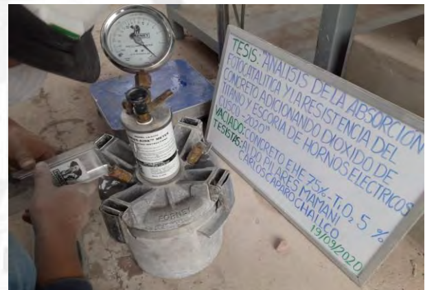
Olla Washington, medición de contenido de aire concreto (EHE 75%, TIO2 5%)
