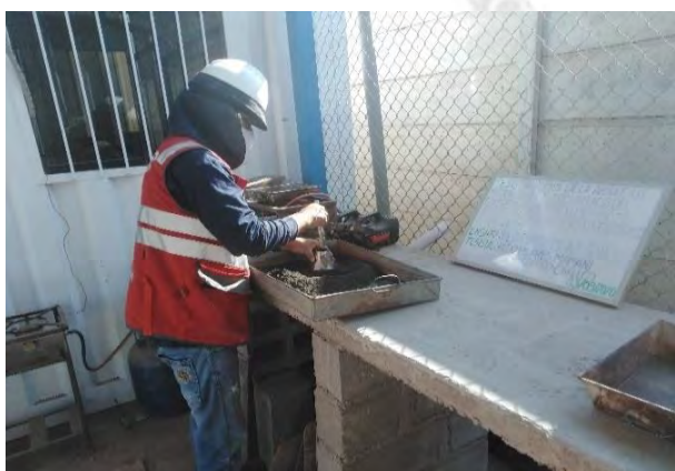
Determinación del estado saturado superficialmente seco del Agregado fino de Escoria de hornos ELÉCTRICOS.
