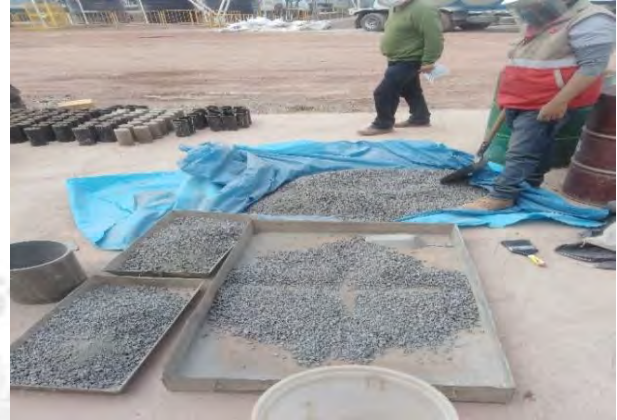
Cuarteo de Agregado de \frac{3}{4} de Escoria de hornos ELÉCTRICOS.
