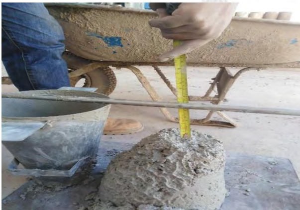
Determinación de Asentamiento del concreto de (EHE 75%, TIO2 10%)
