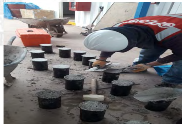
Moldeo de las briquetas del concreto (EHE 25%, TIO2 7.5%) (4"x8") VACIADO DEL CONCRETO CON EHE 25% Y TIO2 10%
