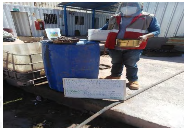
Lavado por la malla 200 agregado grueso de Supermix.
