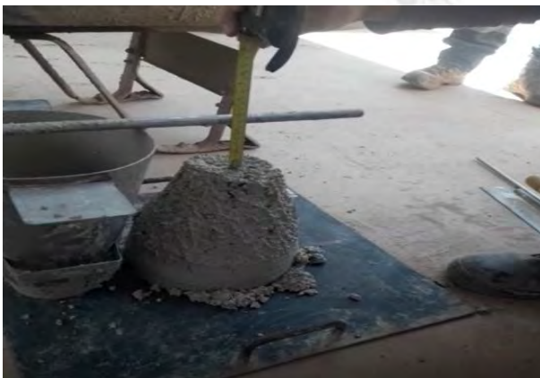
Determinación de Asentamiento del concreto de (EHE 25%, TIO2 7.5%)
