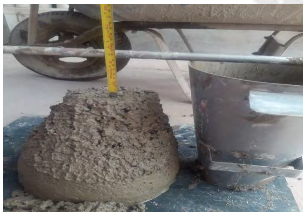
Determinación de Asentamiento del concreto de (EHE 25%, TIO2 5%)
