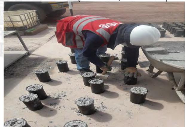
Moldeo de las briquetas del concreto (EHE 75%, TIO2 7.5%) (4"x8") VACIADO DEL CONCRETO CON EHE 75% Y TIO2 10%
