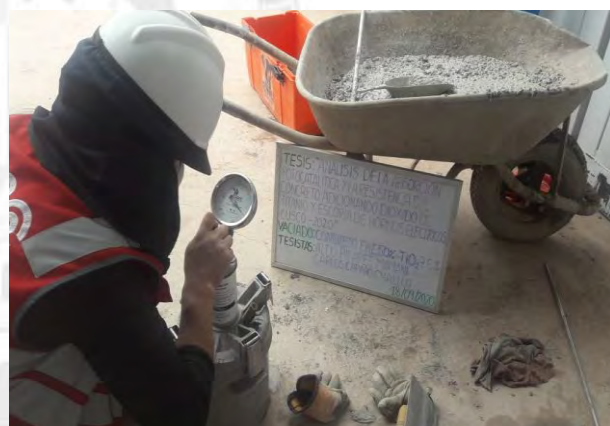
Olla Washington, medición de contenido de aire concreto (EHE 50%, TIO2 7.5%)
