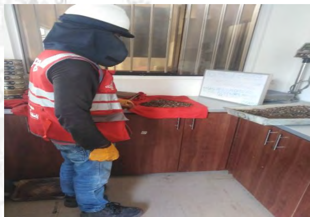
Secado con franela para Peso Especifico y Absorción de Agregado grueso de Supermix.
