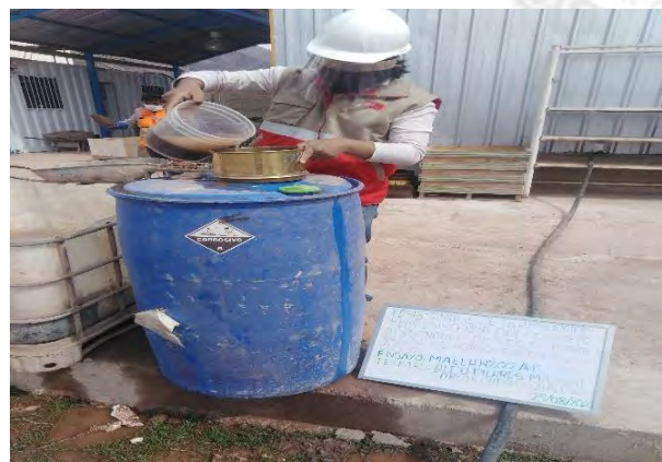
Lavado por la malla 200 de fino agregado de Supermix
