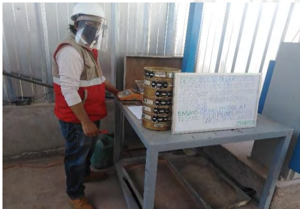
Tamizado de agregado fino agregado de Supermix
