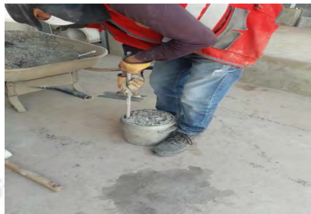
Proceso para determinar contenido de aire del (EHE 25%, TIO2 10%)
