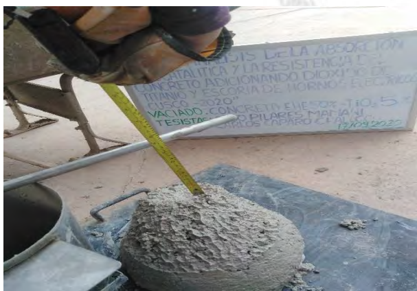
Determinación de Asentamiento del concreto de (EHE 50%, TIO2 5%)
