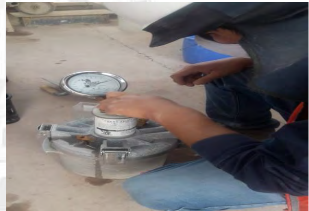
Olla Washington, medición de contenido de aire concreto (EHE 25%, TIO2 5%)
