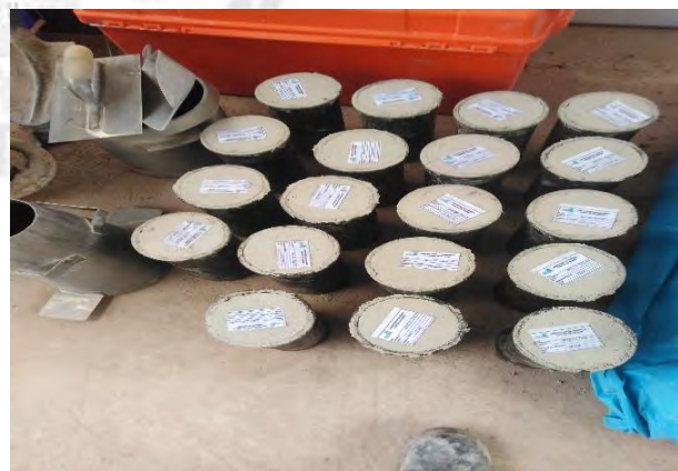
Moldeo de las briquetas del concreto (EHE 25%, TIO2 10%) (4"x8") VACIADO DEL CONCRETO CON EHE 50% Y TIO2 5%
