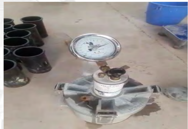
Olla Washington, medición contenido de aire del concreto(CC)
