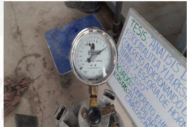
Olla Washington, medición de contenido de aire concreto (EHE 75%, TIO2 10%)
