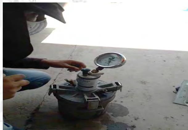
Olla Washington, medición de contenido de aire concreto (EHE 25%, TIO2 10%)
