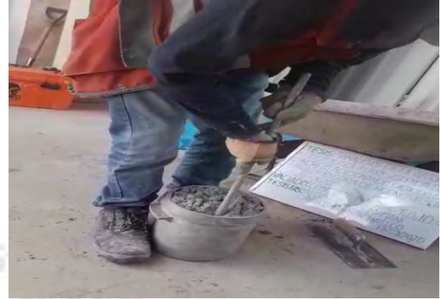
Proceso para determinar contenido de aire del (EHE 75%, TIO2 10%)
