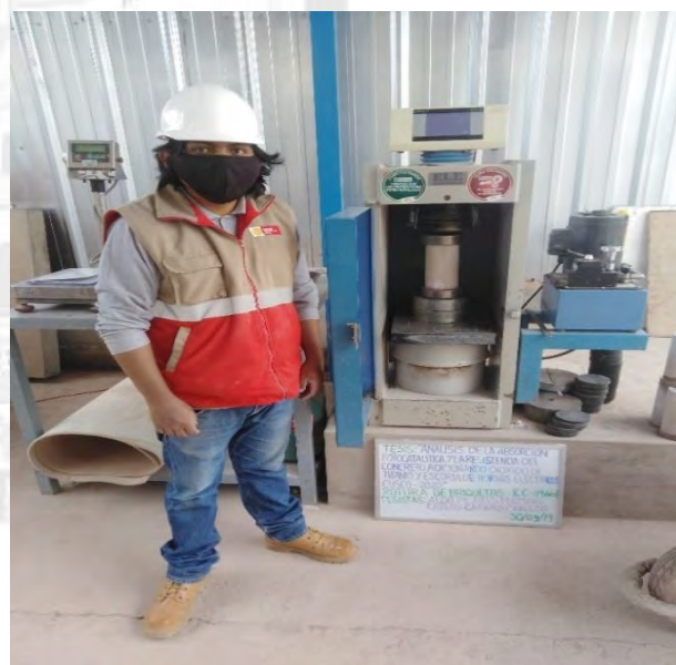
Rotura de briquetas
