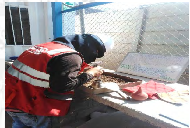
Determinación del estado saturado superficialmente seco del Agregado fino de Supermix
