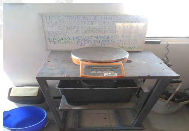
Pesado en canastilla sumergida para ensayo Peso especifico y Absorción de Agregado grueso de Superman.
