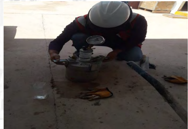
Olla Washington, medición de contenido de aire concreto (EHE 25%, TIO2 7.5%)
