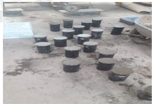
Moldeo de las briquetas del concreto (EHE 25%, TIO2 5%) (4"x8") VACIADO DEL CONCRETO CON EHE 25% Y TIO2 7.5%
