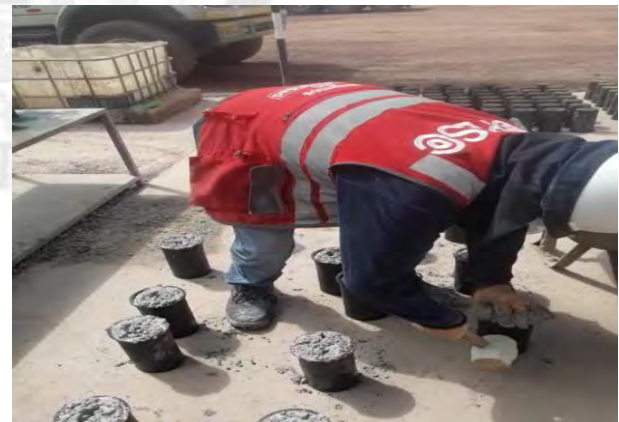
Moldeo de las briquetas del concreto (EHE 75%, TIO2 10%) (4"x8")
