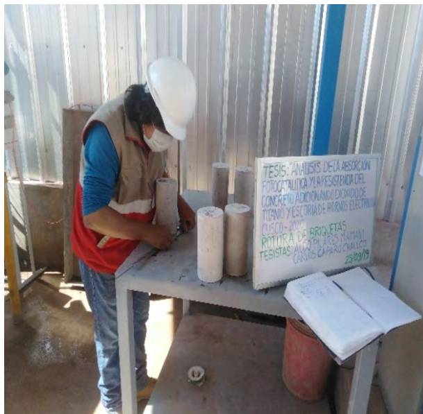
Medición y peso de las briquetas
