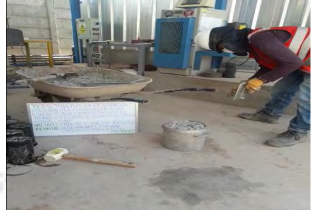
Control de temperatura del concreto (EHE 25%, TIO2 7.5%)
