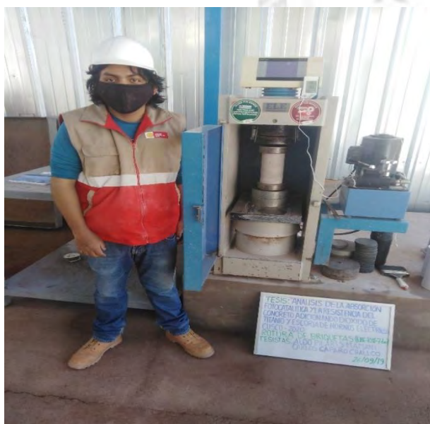
Rotura de briquetas
