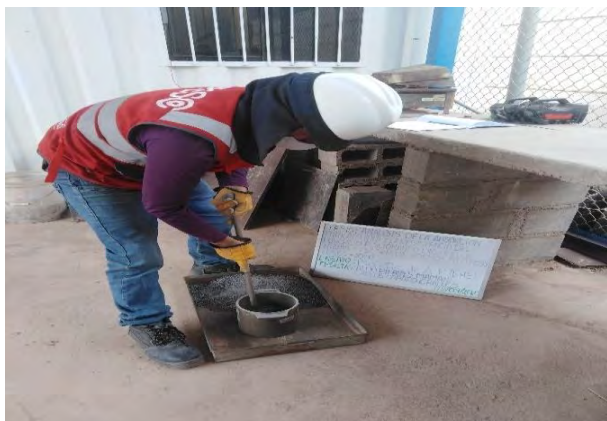
Compactado para Peso seco compactado de Agregado fino de Escoria de hornos ELÉCTRICOS.
