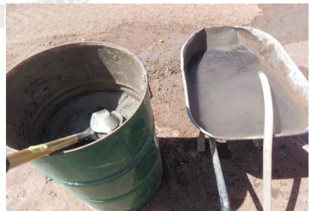
Lavado de agregado fino de Escoria de hornos ELÉCTRICOS.
