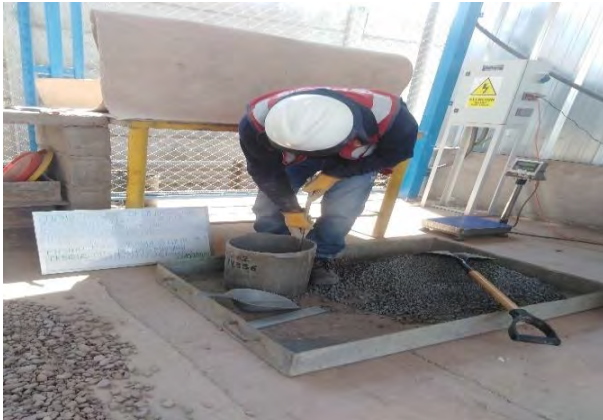
Peso seco suelto y Peso seco compactado de Agregado grueso de Escoria de hornos ELÉCTRICOS.
