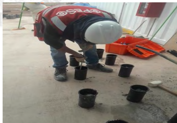
Moldeo de las briquetas del concreto (EHE 50%, TIO2 7.5%) (4"x8")
