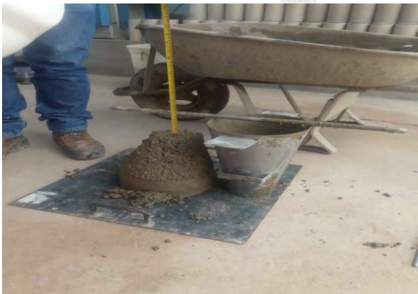
Determinación de Asentamiento del concreto de (CC)
