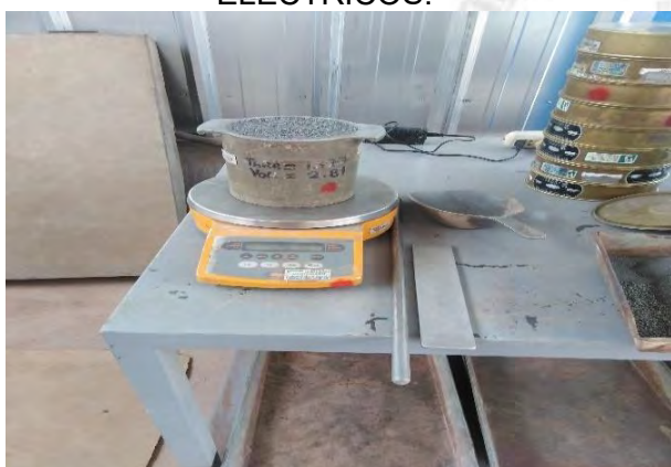
Pesado para Peso seco compactado de Agregado fino de Escoria de hornos ELÉCTRICOS.
