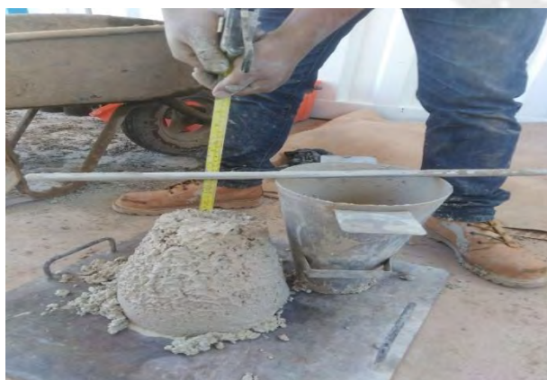
Determinación de Asentamiento del concreto de (EHE 50%, TIO2 7.5%)
