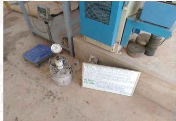
Olla Washington, medición de contenido de aire concreto (EHE 75%, TIO2 7.5%)
