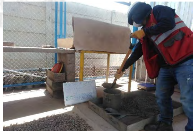
Colocado de Agregado grueso de Escoria de hornos ELÉCTRICOS en recipiente para Peso seco suelto y Peso seco compactado.
