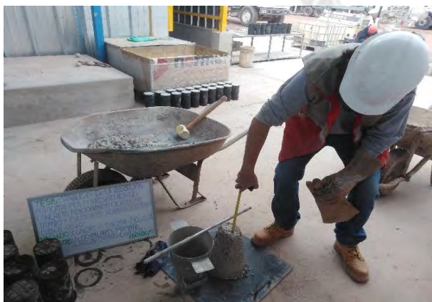
Determinación de Asentamiento del concreto de (EHE 25%, TIO2 10%)
