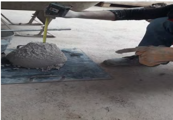
Determinación de Asentamiento del concreto de (EHE 50%, TIO2 10%)
