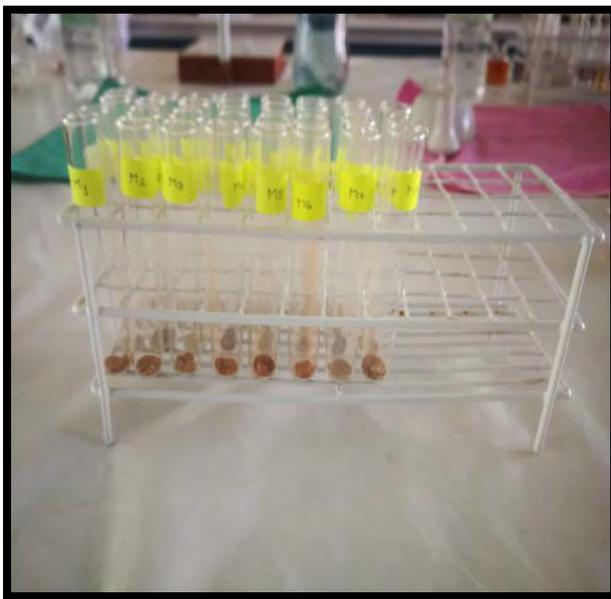
Fotografía N° 7: Determinación de cenizas en muestras previamente sometidas a calcinación.
