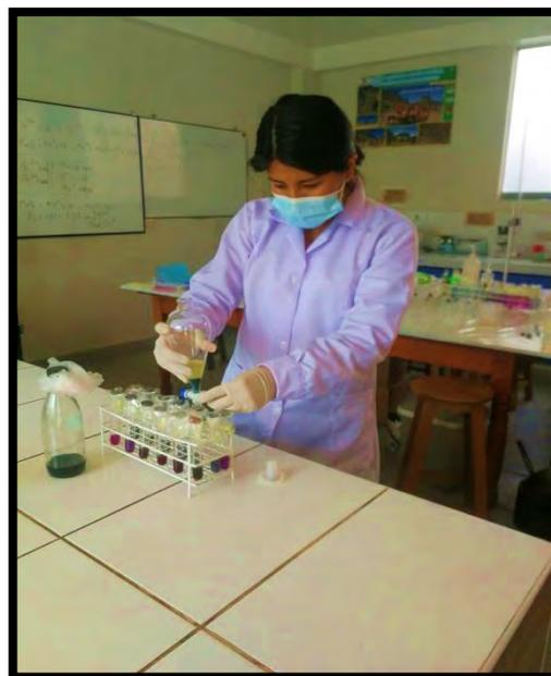
Fotografía N°14: Extracción de plomo mediante el complejo ditizona- cloroformo.
