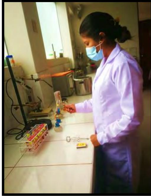
Fotografía N° 6: Determinación de pH de las muestras cosméticas, mediante la utilización del potenciómetro.
