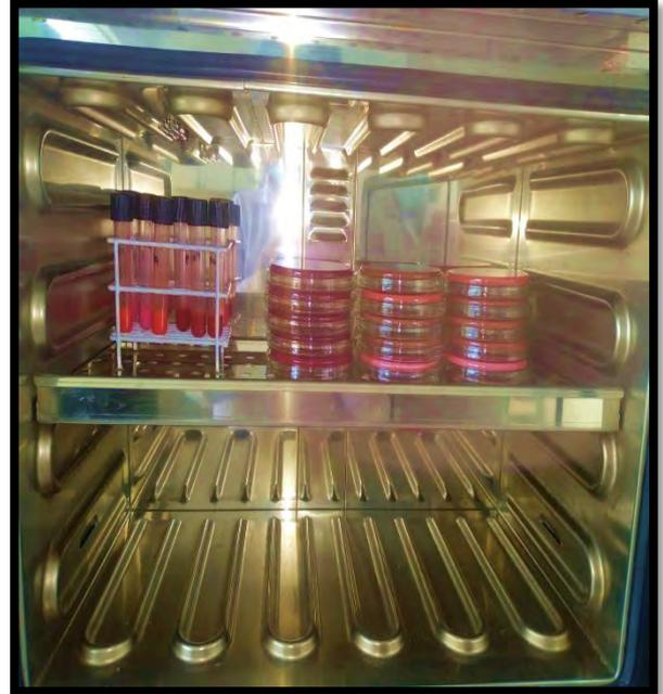
Fotografía N° 10: Incubación de las placas a una temperatura de 30-35°C.
