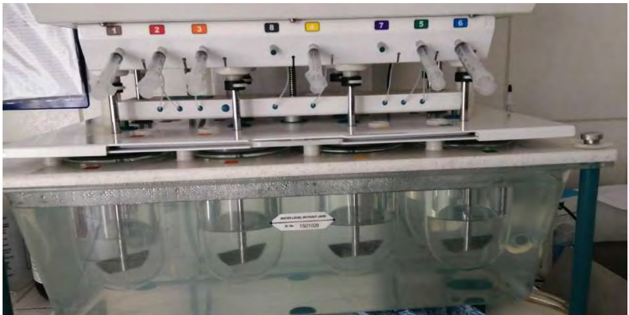
FOTOGRAFÍA 6 DISOLUCIÓN DE PARACETAMOL 500mg TABLETAS
