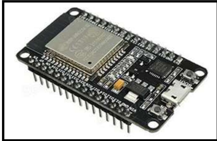
Figura 6. Microcontrolador dual Core de 32 bits ESP32 ("PROMOTEC", 2021).
