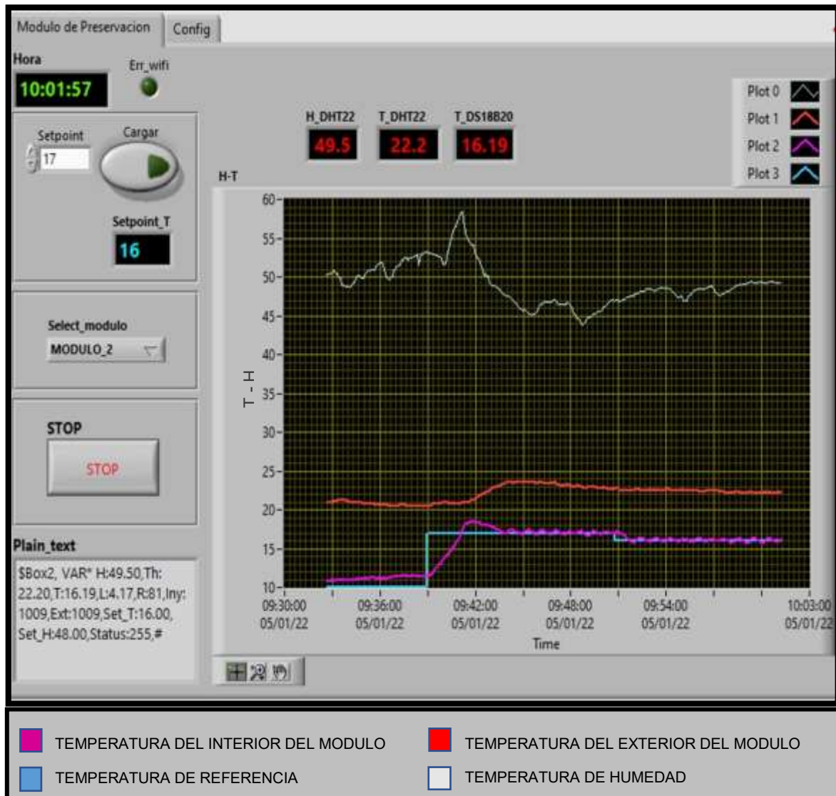
Figura 39. Prueba de control de temperatura y monitoreo, de humedad relativa en la biblioteca del museo Inka con setpoint 16 °C.
