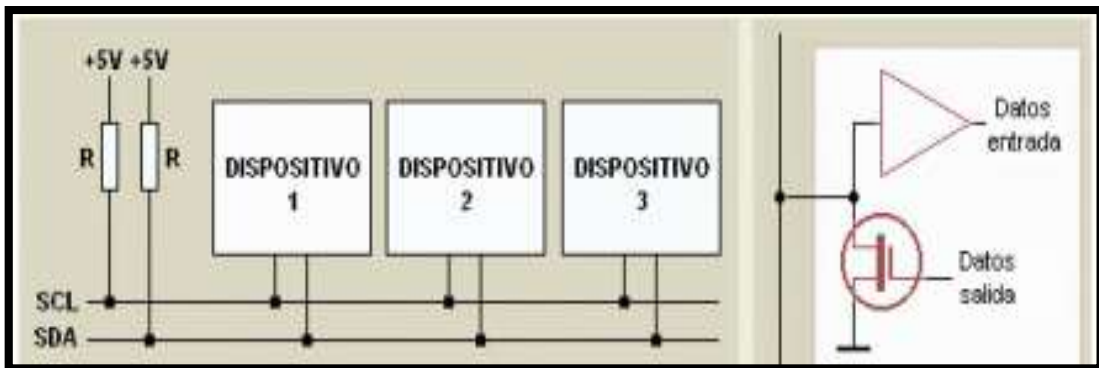
Figura 4. Diagrama de las dos líneas del bus en un nivel lógico alto cuando.
