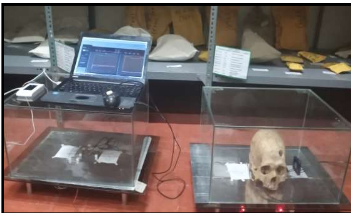
Figura 42. Prueba Validación del funcionamiento del sistema para la conservación de huesos en diferentes setpoint.
