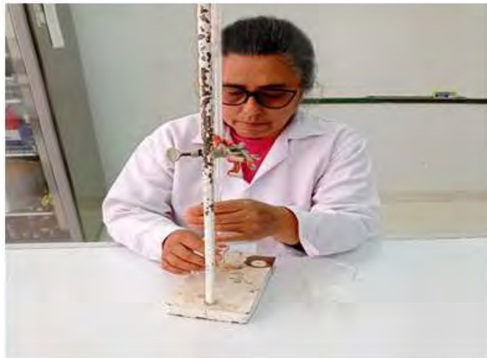
Figura 13. Titulando para determinar el índice de acidez (IA)
