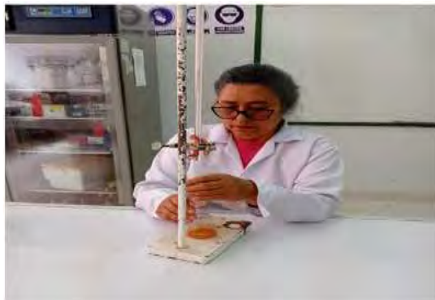
Figura 15. Titulando para determinar el índice de saponificación (IS)
