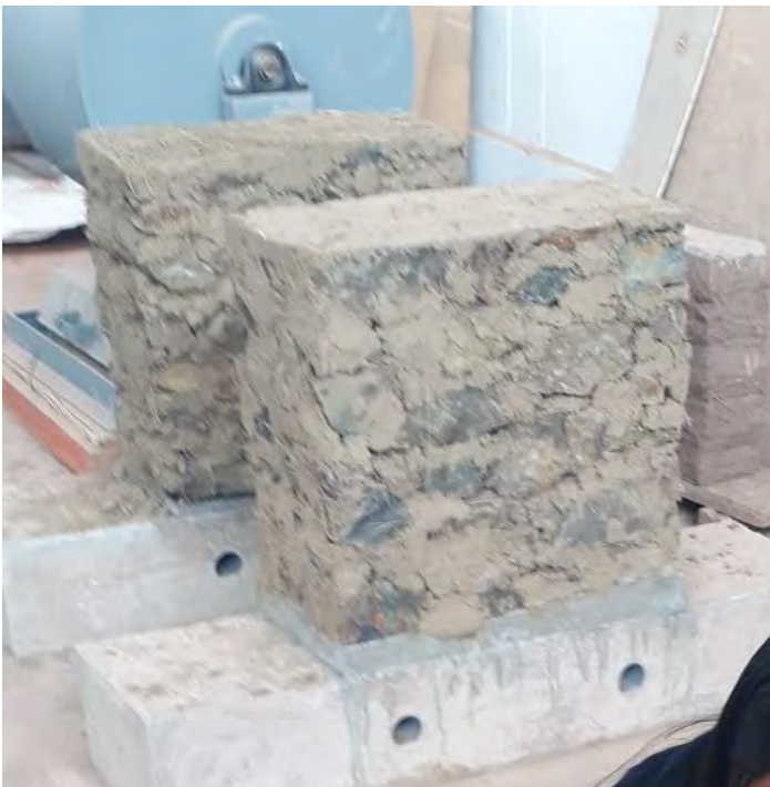
Figura 20 Desencofrado de muro asentado
