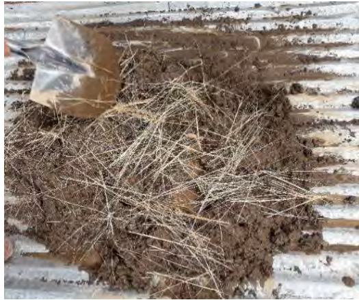
Figura 15 Mezcla de mortero de barro y paja
