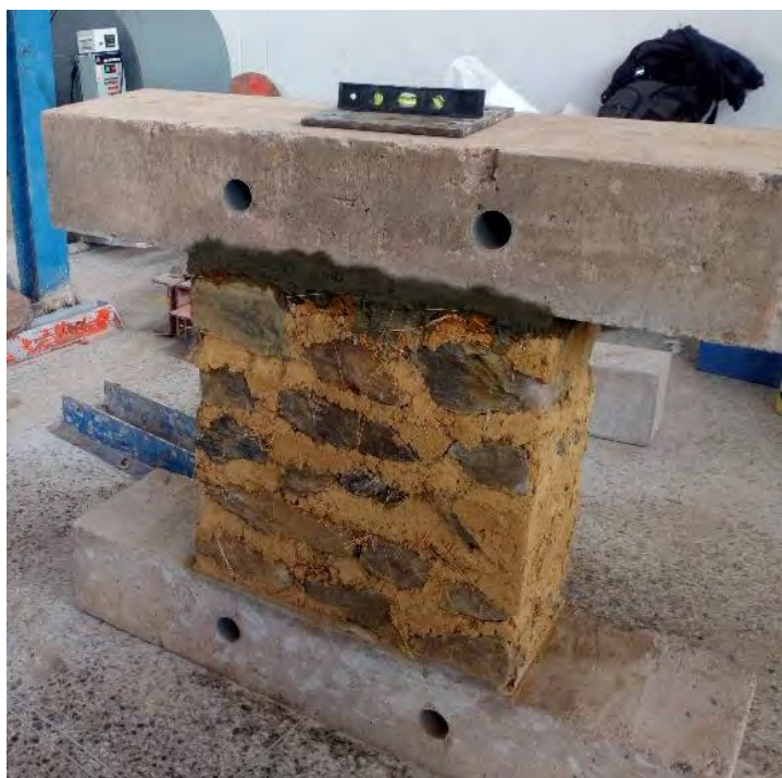
Figura 21 Colocación de Viga de Concreto.
