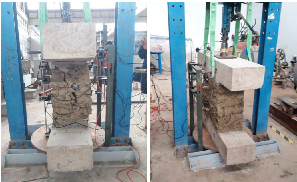
Figura 28 Ubicación de diales en muros de mampostería
