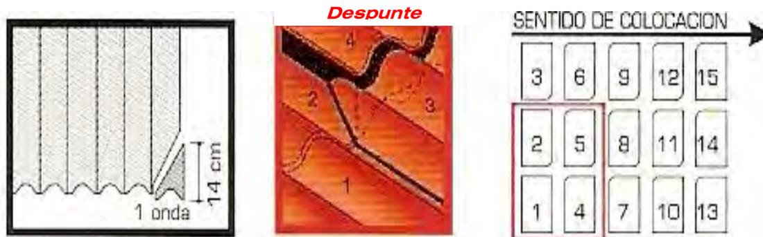
Para evitar la superposición de 4 planchas se deberá despuntarse las planchas intermedias y el contendrá 1 onda (10 cm. aprox.) y ¼ de onda (4.7 cm. aprox.) de ancho y de un largo igual al traslape longitudinal. Como se verá en el grafico siguiente.
