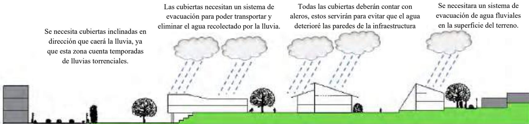
**Figura 179.** Orientación de precipitaciones pluviales (2020).
