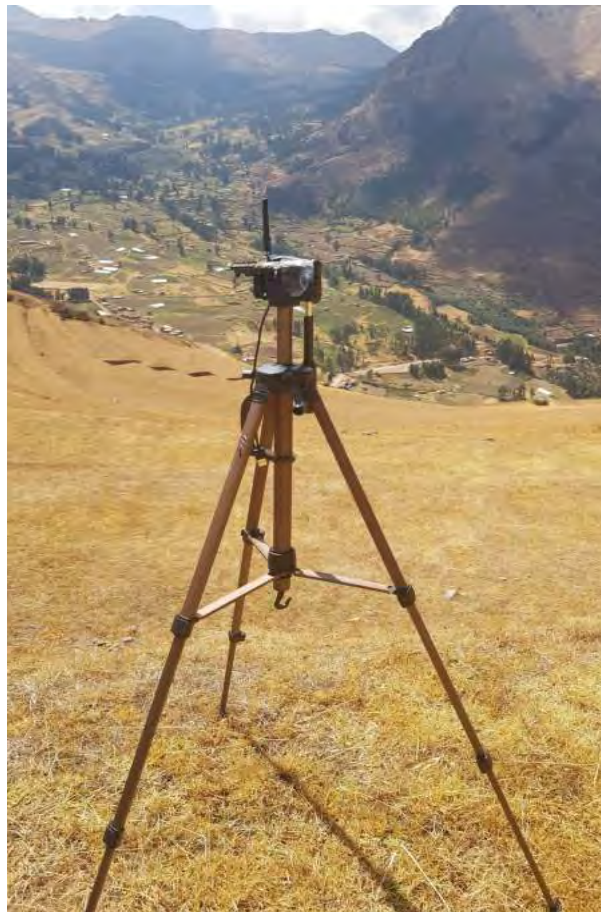
Figura 3.2: Soporte para antenas
