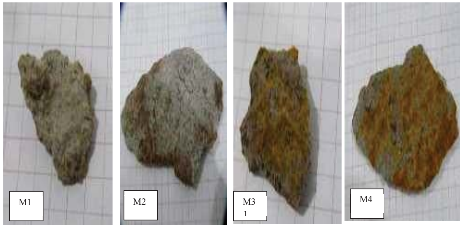
Figura 4: Registro fotográfico de fragmentos líticos de: M1 cantera, M2 erosionados, M3 salinizados y M4 colonizados por el líquen) (Elaboración propia)
