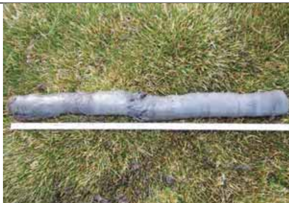
Medición de estratos inferiores obtenidos con el barreno de 4".
