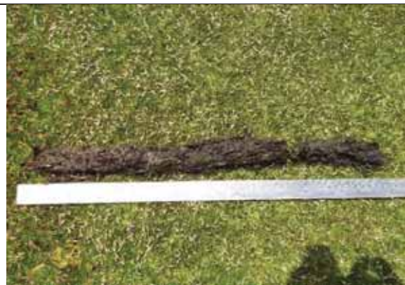
Medición de la turba obtenida con el barreno de 4".
