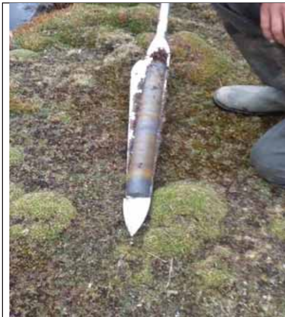
Obtención de núcleos con barreno de 4".
