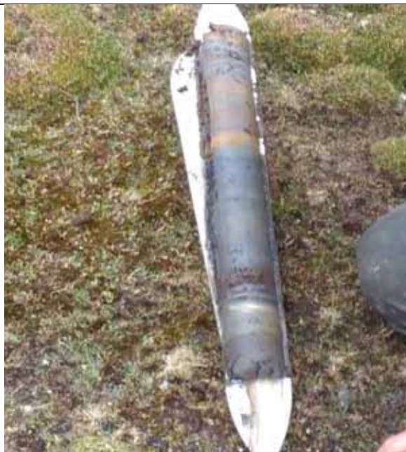
Obtención de núcleos con barreno de 4".
