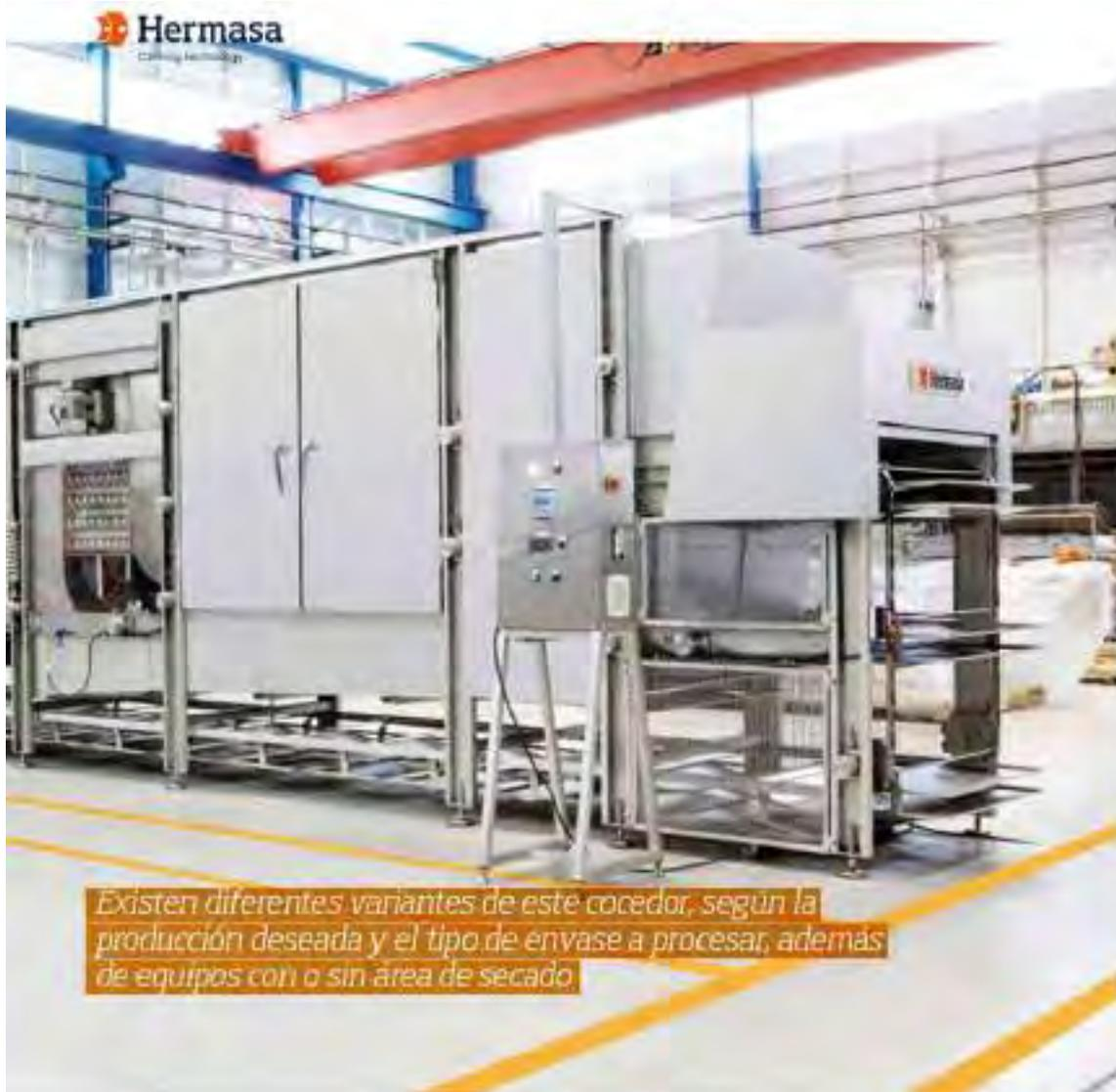
*Existen diferentes variantes de este cocedor, según la producción deseada y el tipo de envase a procesar, además de equipos con o sin área de secado.*
