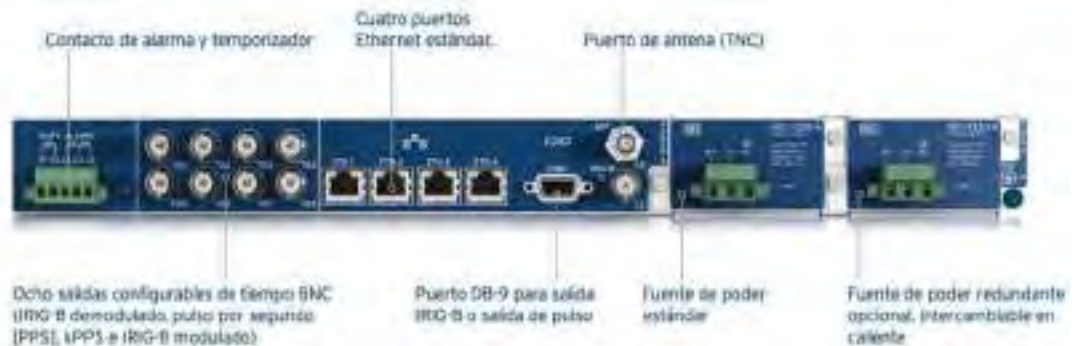
Figura 66 - Vista posterior, Reloj de sincronización SEL-2488
