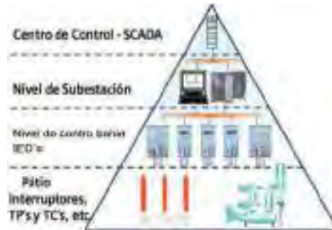
Figura 8 Niveles jerárquicos de control en una SET
