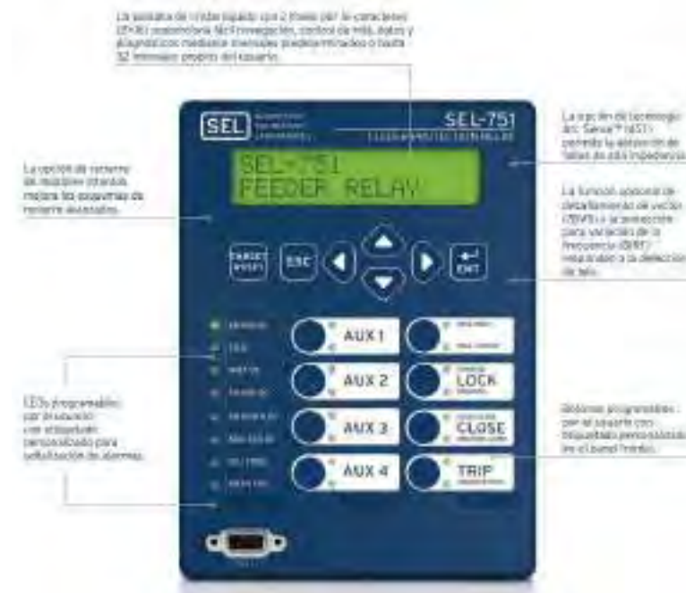
Figura 58 - Vista Frontal, Relé de protección SEL-751
