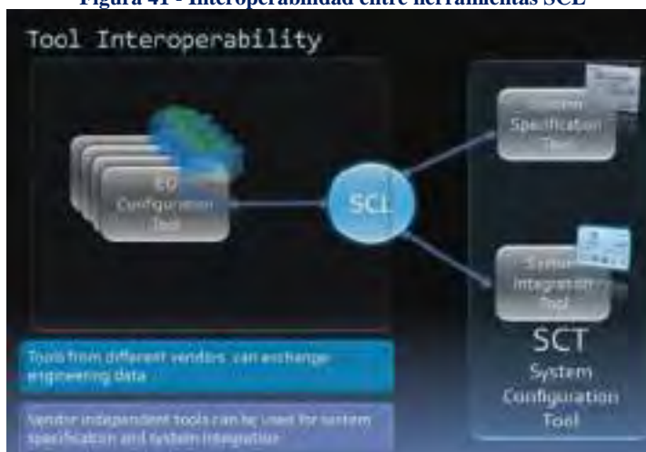
Figura 41 - Interoperabilidad entre herramientas SCL
