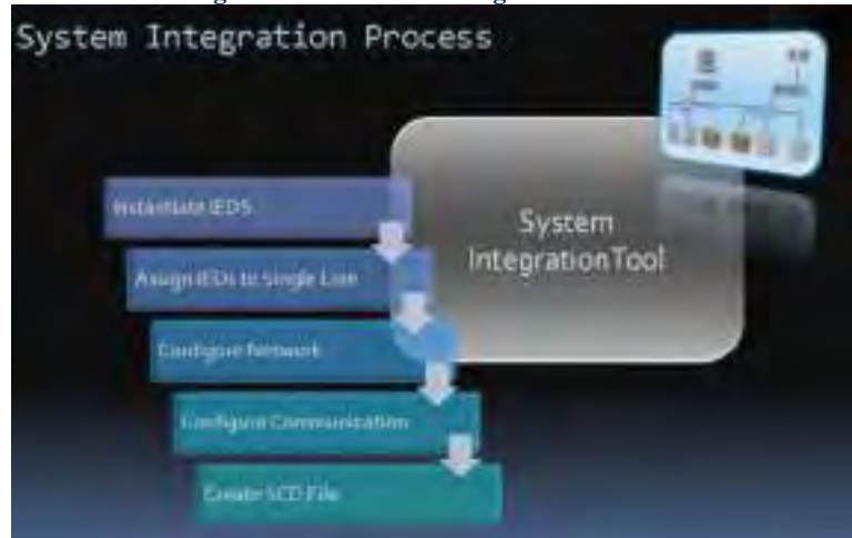
Figura 44 - Proceso de integración del SAS
