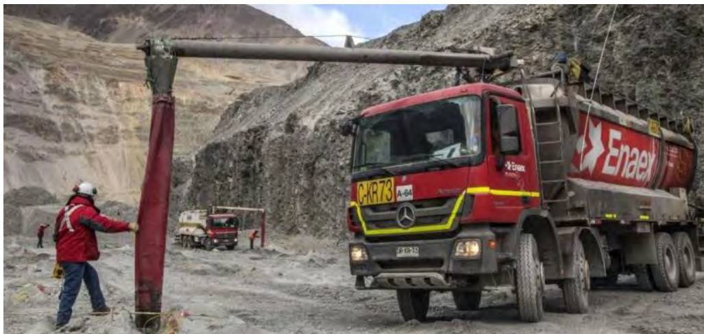
Imagen 9: Carguío con explosivo los taladros
