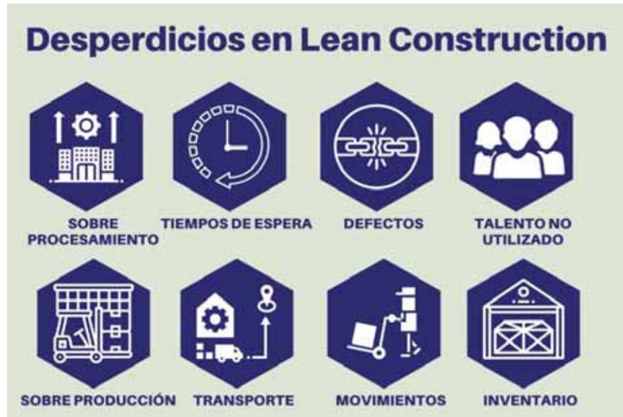
Figura N° 8: Desperdicios en Lean Construction
