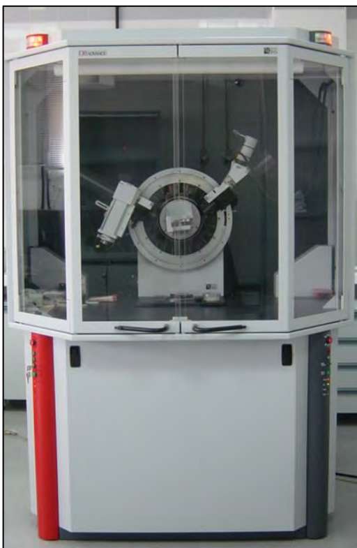
Imagen 11: Difractómetro de rayos X, marca BRUKER modelo D8 ADVANCE, de la Universidad de Huelva Fuente: Servicios Centrales I + D de la Universidad de Huelva
