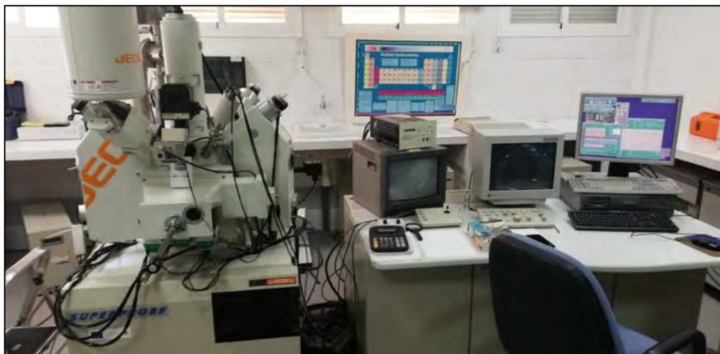
Imagen 13: Microsonda electrónica marca JEOL, modelo JXA-8200 SuperProbe; Universidad de Huelva – España.
