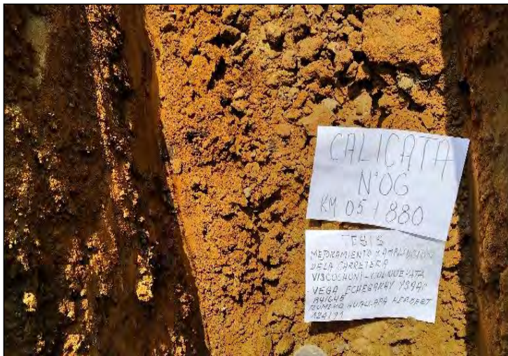
Fotografía 3-22: PROFUNDIDAD DE EXCAVACION 1.70m CON COBERTURA, SIN PRESENCIA DE NIVEL FREATICO
