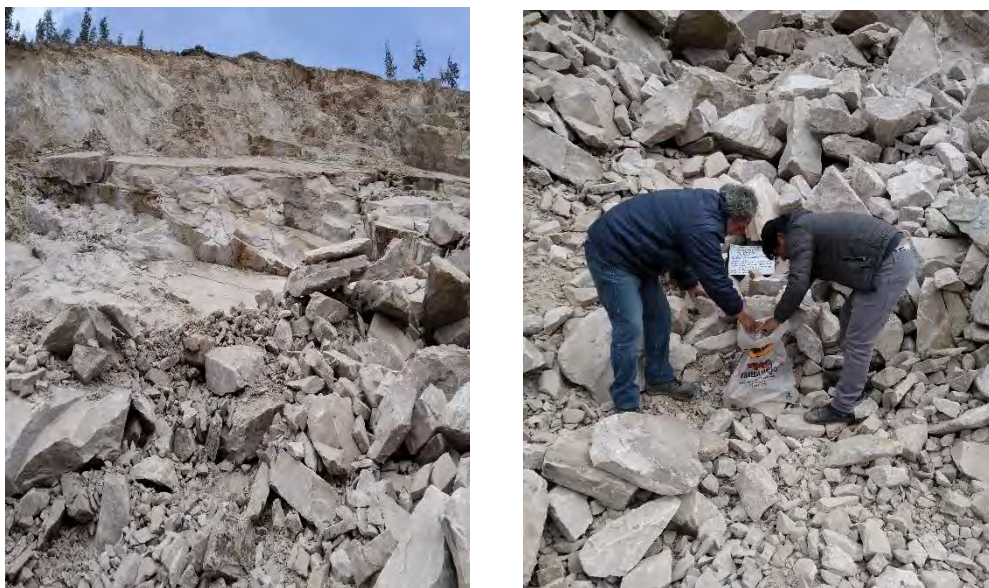
Fotografía 3-58 y 3-59: Cantera km. 15+800 de la vía Huambutio-Paucartambo conocida por el nombre de la comunidad de Huayllabamba “Cantera Huayllabamba”, extracción de muestra para el análisis en el laboratorio.
