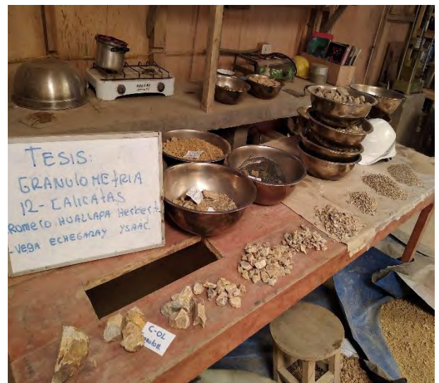
Fotografía 3-43, 3-44, 3-45 y 3-46: Proceso de granulometría; cuarteo, lavado, secado en horno, tamizado.
