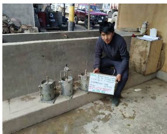
Fotografía 3-52 y 3-53: Proceso de CBR, pasante malla 3/4, contenido optimo humedad, golpes 56,25 y 12, medición de la expansión 24hs y 5 días después de ser sumergido en agua, lectura en la prensa CBR óptima. Se evidencia la calicata 03.
