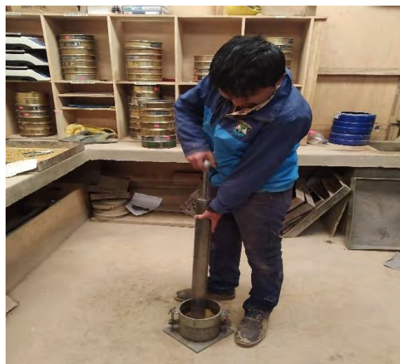
Fotografía 3-50 y 3-51: Proceso de Proctor Modificado; pasante malla \frac{3}{4} , golpes 56, cuatro moldes con diferentes cantidades de humedad para llegar a la humedad óptima. Se evidencia la calicata 03.
