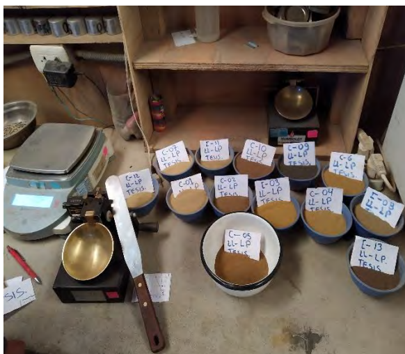
Fotografía 3-47 y 3-48: Proceso de limite liquido; pasante malla N° 40, numero de golpes 38, 28,21 y 15.
