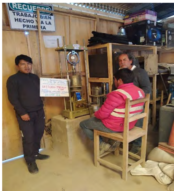
Fotografía 3-54 y 3-55: Proceso de CBR, lectura en la prensa con la ayuda de un técnico, evidencia la calicata 03, última fecha de calibración de la prensa fue.17/09/2019.
