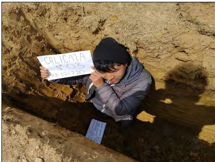
Fotografía 3-16: PROFUNDIDAD DE EXCAVACION 1.60m, SIN PRESENCIA DE NIVEL FREATICO
