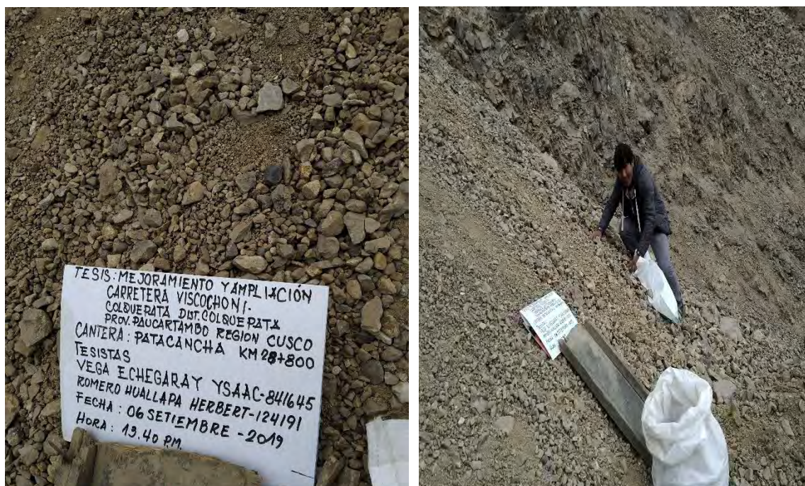
Fotografía 3-56 y 3-57: Cantera km. 28+800 de la vía Huambutio-Paucartambo conocida por el nombre de la comunidad de Patacancha “Cantera Patacancha”, extracción de muestra para el análisis en el laboratorio.
