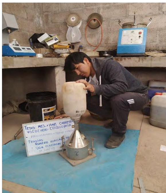
Fotografía 4-2 y 4-3: Angularidad y Caras chatas –largas. Se muestra el proceso de angularidad de arena chancada y selección de caras chatas-largas. Fuente: Elaboración propia.
