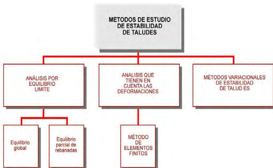
Figura 4-34: Métodos de estudio de estabilidad de taludes
