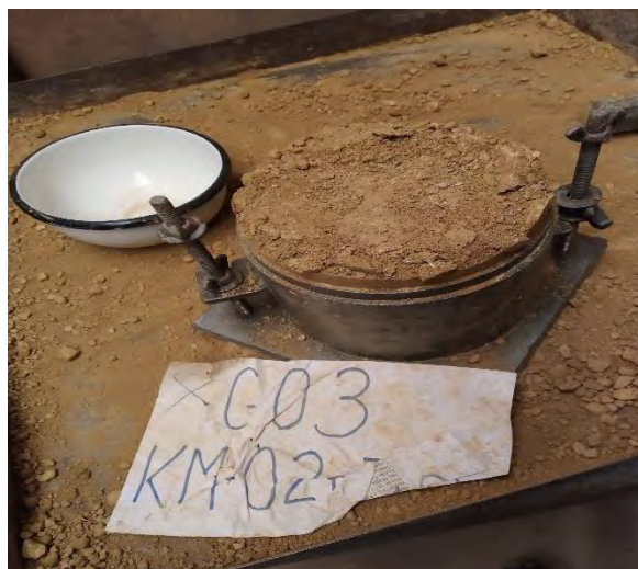
Fotografía 3-50 y 3-51: Proceso de Proctor Modificado; pasante malla \frac{3}{4} , golpes 56, cuatro moldes con diferentes cantidades de humedad para llegar a la humedad óptima. Se evidencia la calicata 03.
