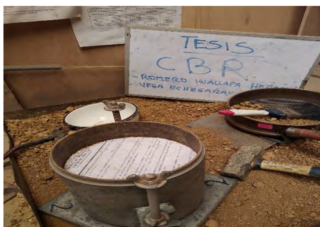
Fotografía 3-52 y 3-53: Proceso de CBR, pasante malla 3/4, contenido optimo humedad, golpes 56,25 y 12, medición de la expansión 24hs y 5 días después de ser sumergido en agua, lectura en la prensa CBR óptima. Se evidencia la calicata 03.
