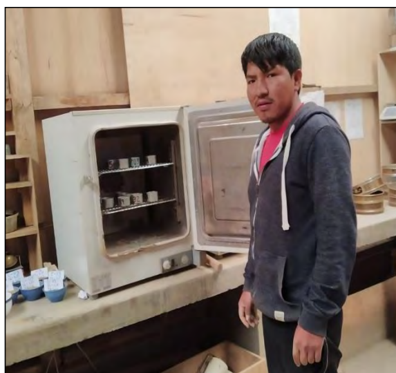
Fotografía 3-41 y 3-42: Proceso de secado de muestra húmeda-Laboratorio gobierno regional, horno eléctrico.
