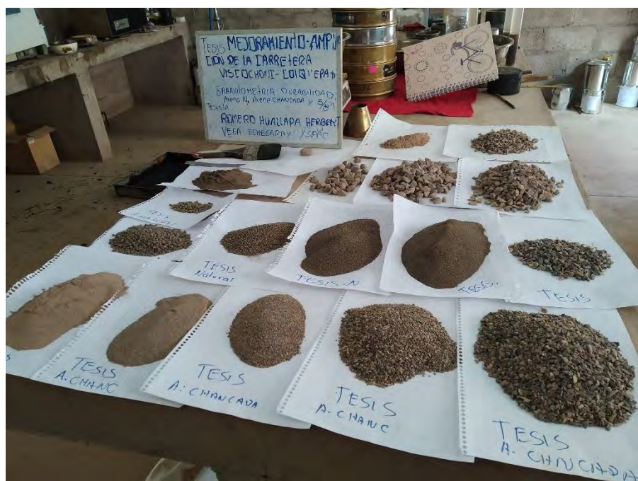
Fotografía 4-1: Agregados grueso y fino seleccionados. Granulometría para durabilidad de arena natural y piedra chancada.
