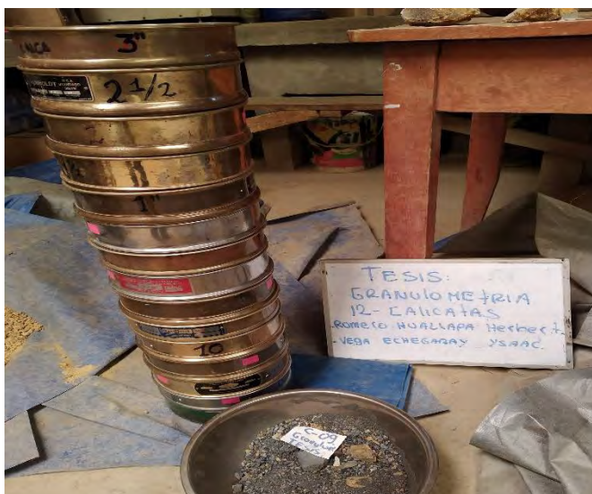
Fotografía 3-43, 3-44, 3-45 y 3-46: Proceso de granulometría; cuarteo, lavado, secado en horno, tamizado.
