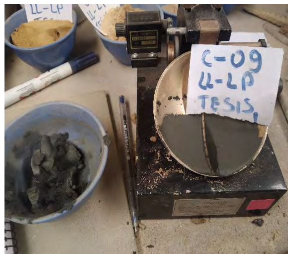
Fotografía 3-47 y 3-48: Proceso de limite liquido; pasante malla N° 40, numero de golpes 38, 28,21 y 15.
