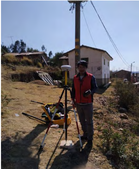
Fotografía 3-3: Ubicación punto de control con GPS diferencial-UNSAAC. (PG-1)
