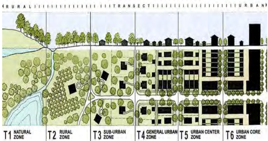
Figura 79: esquema de crecimiento urbano alternativo combinando las ventajas de lo urbano y rural, Transect Planning (Fuente: https://transect-collection.org/ )
