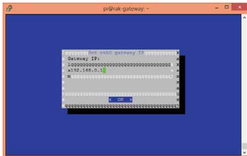
Figura 64: Configuración de la puerta de enlace del Router (Elaboración propia).
