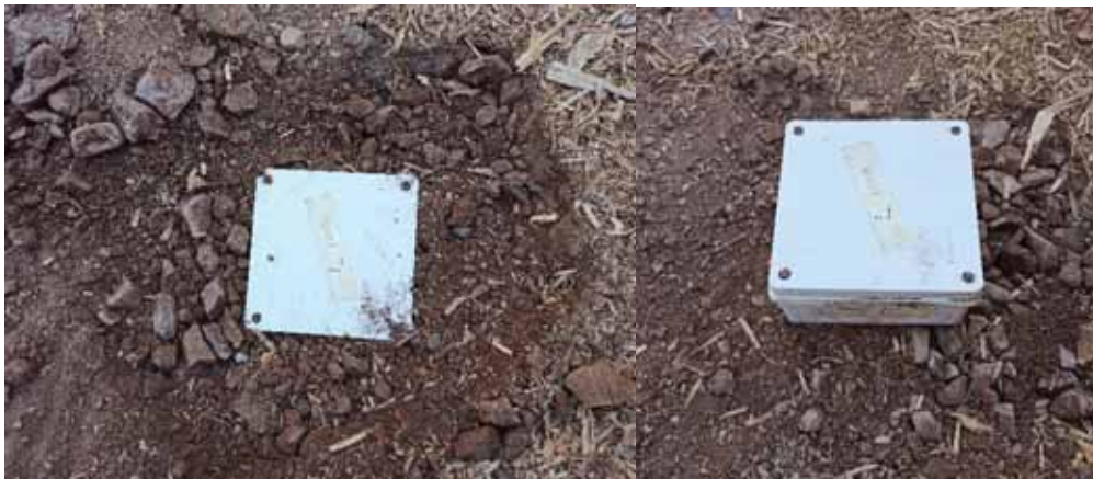
Figura 35: Medición del campo magnético terrestre cuando el nodo sensor se encuentra enterrado y sobre la superficie del suelo (Elaboración propia).
