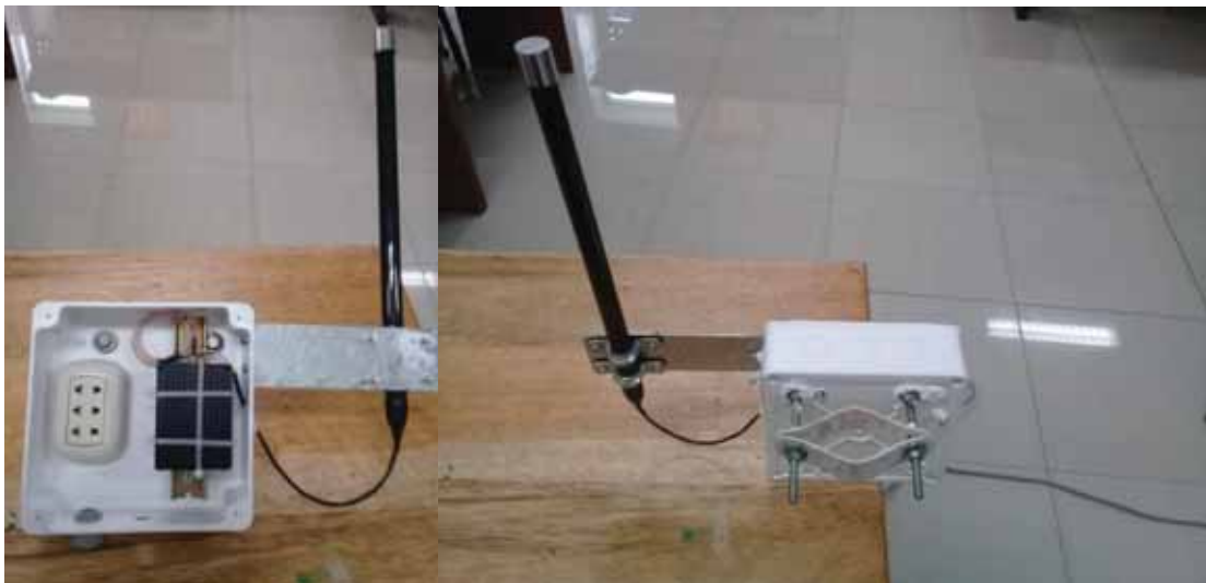
Figura 20: Acondicionamiento del gateway para la intemperie (imagen frontal y posterior) (Elaboración propia).
