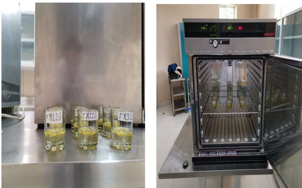
Fotografía N° 6. Operación unitaria de inmersi6n de la materia prima (ki6n) en la soluci6n osm6tica.
