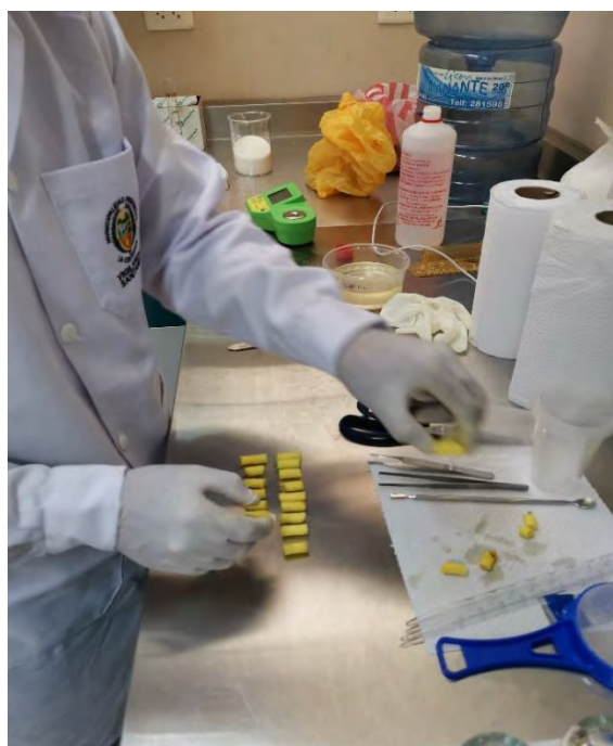
Fotografía N°4. Operación unitaria de troceado del kión ( Zingiber officinale roscoe ) con una longitud de 9.23mm y un espesor de 0.1mm.
