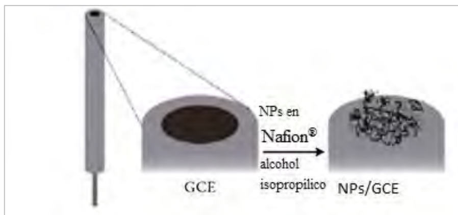
Figura 24: Modificación del electrodo de glassy carbon con NPs de Ni y Pd (fuente: elaboración propia).
