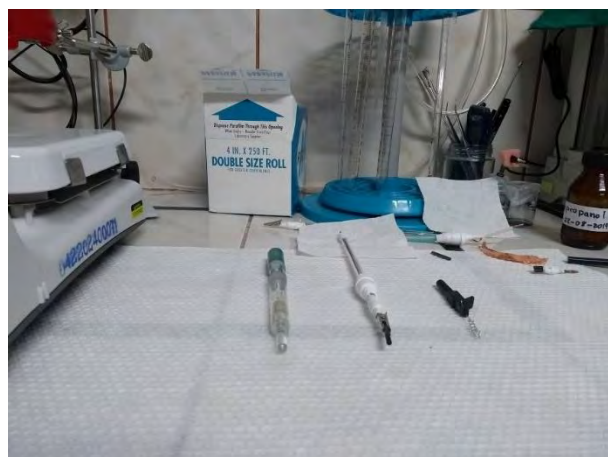
Imagen de los electrodos utilizado: Ag/AgCl, CGE modificado con NPs y el Alambre de Pt.
