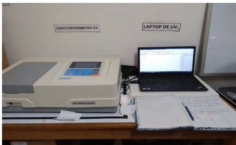
Figura 27: Equipo UV-Vis marca BIOBASE modelo BK-D580 de doble celda utilizado para la medición de absorbancias de la solución de PQT.
