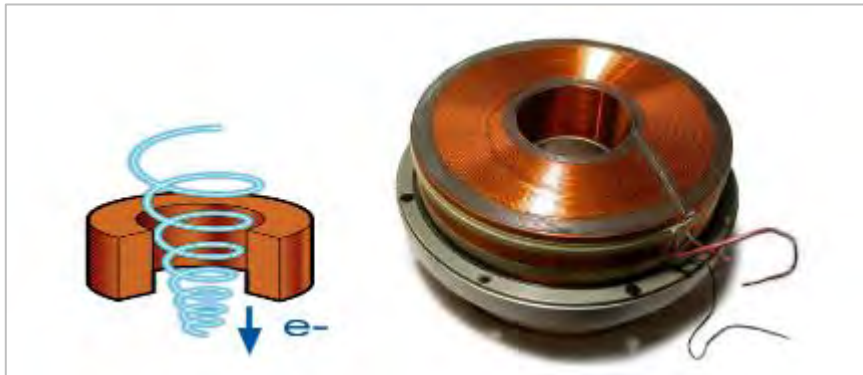
Figura 16: Lentes de un microscopio electrónico de transmisión (fuente: servicios técnicos UA)
