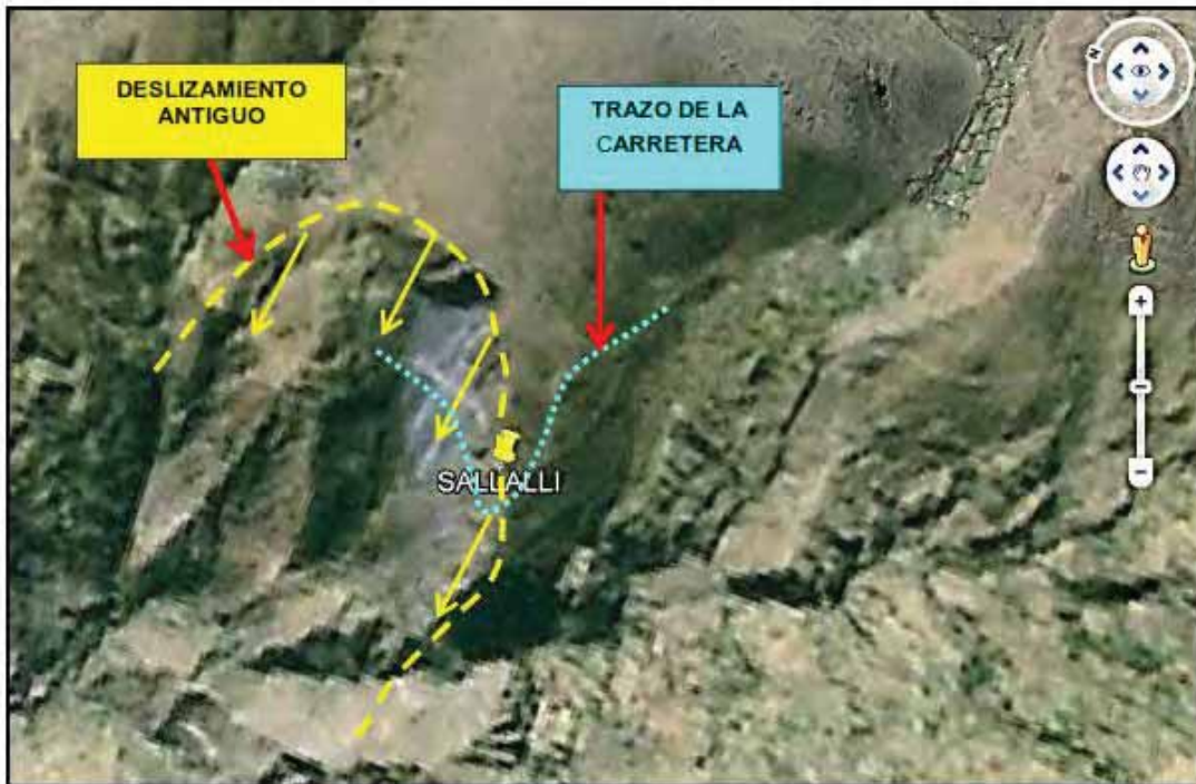
Vista satelital de los sectores críticos sujetos a estudio donde se aprecia que estos pertenecen a un antiguo deslizamiento
