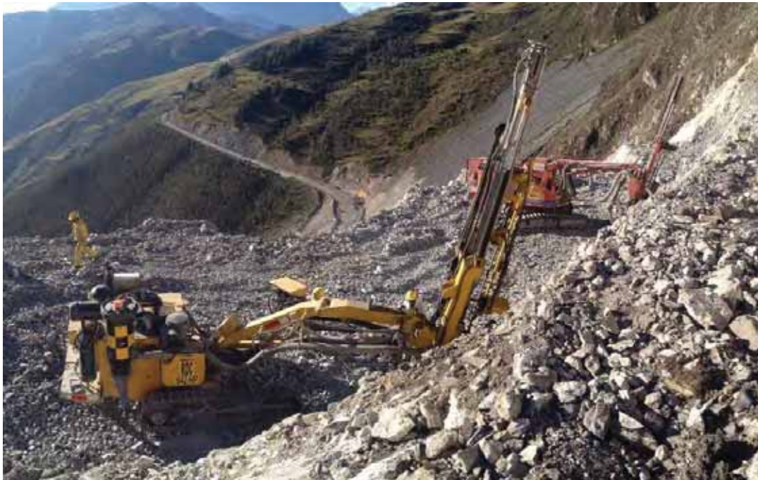
Imagen 12: Rock Drill Atlas Copco ROC 642 HP
