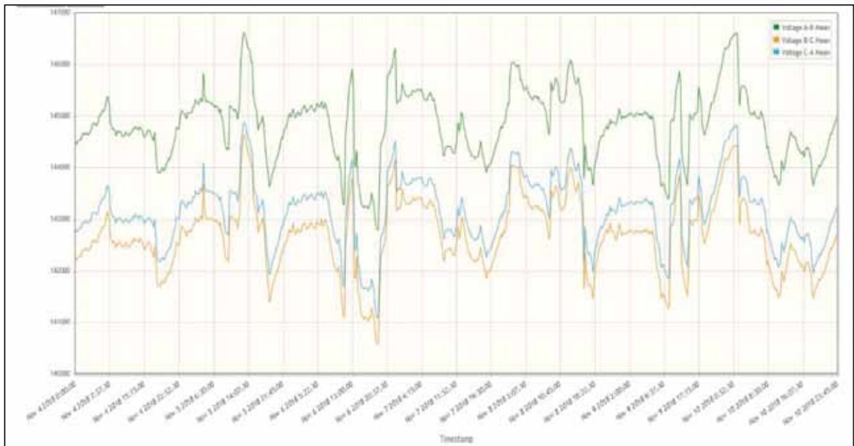
Figura 14: Perfiles de tensión de la línea L-1014 medición desde la SE San Gabán Fuente: Sistema SCADA de Electro Sur Este S.A.A.
