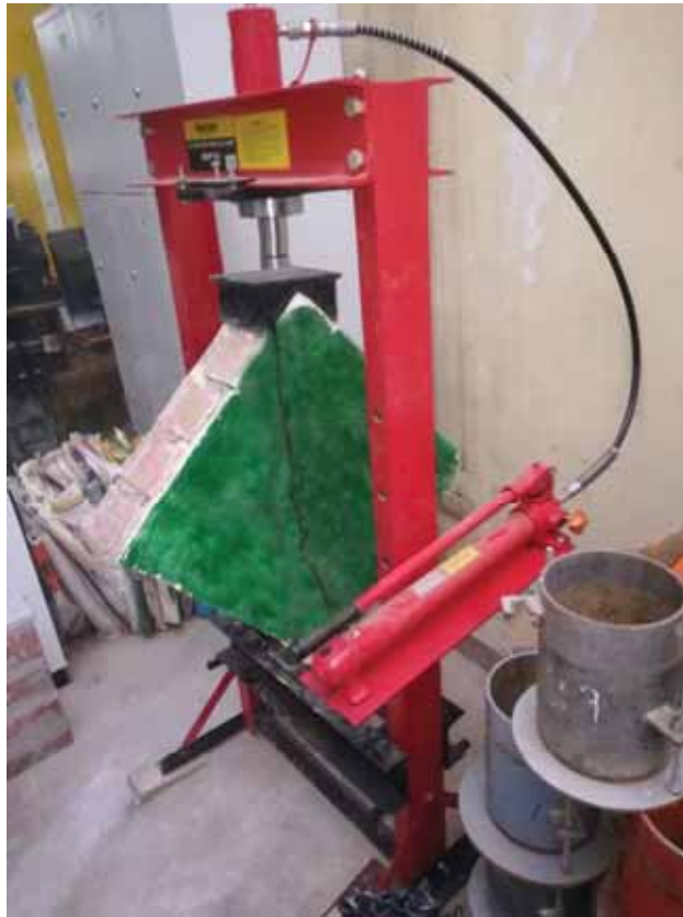
Figura 08: Ensayo a la resistencia al corte diagonal. (Fuente: Elaboración propia).
