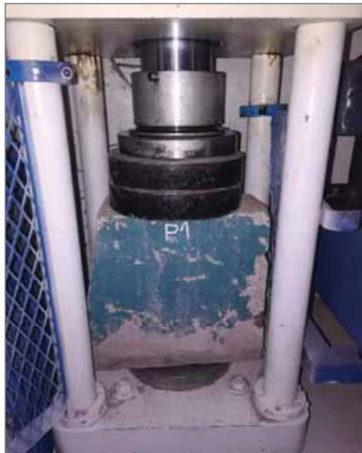
Figura 05: Muestra de pila de albañilería para ensayar a la resistencia a la compresión. (Fuente: Elaboración propia).
