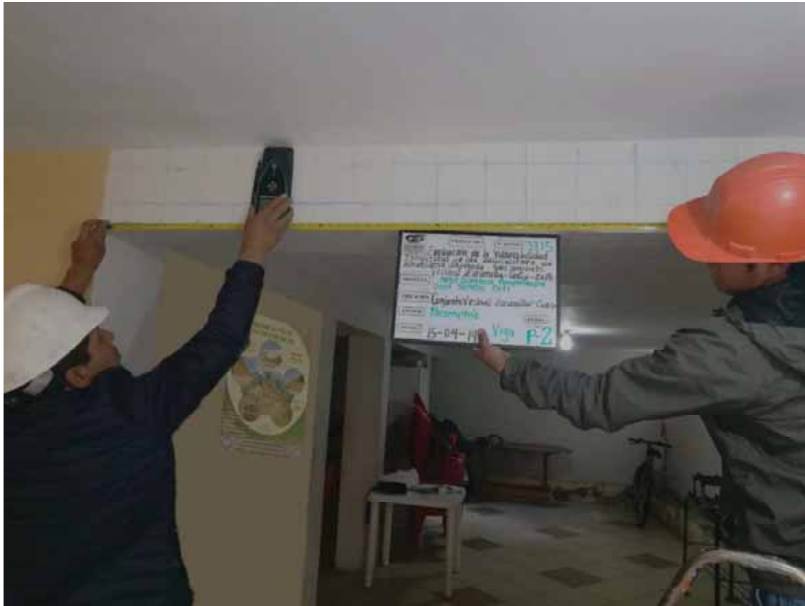
Figura 06: Ensayo de determinación de cuantía de acero y distribución de estribos en vigas y columnas -Pacómetro. (Fuente: Elaboración propia).
