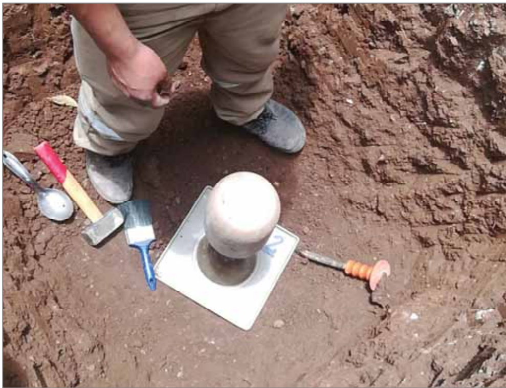
Figura 03: Ensayo de densidad de campo para estudio de suelo. (Fuente: Elaboración propia).
