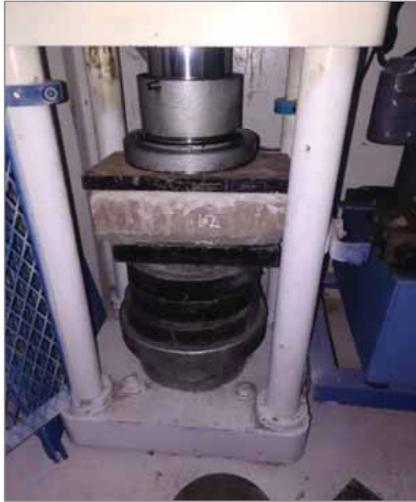
Figura 04: Muestra de unidad de albañilería para ensayar a la resistencia a la compresión. (Fuente: Elaboración propia).
