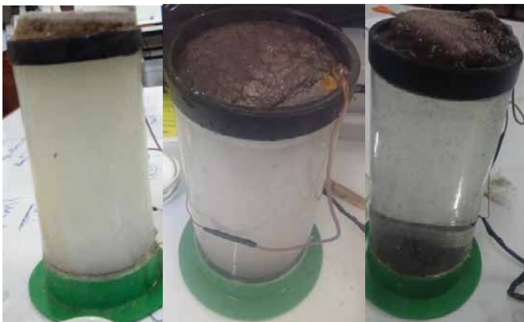
Fotografía 22. Celdas de electroflotación.
