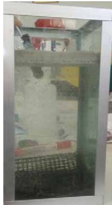
Fotografía 7. Celda de electroflotación preliminar
