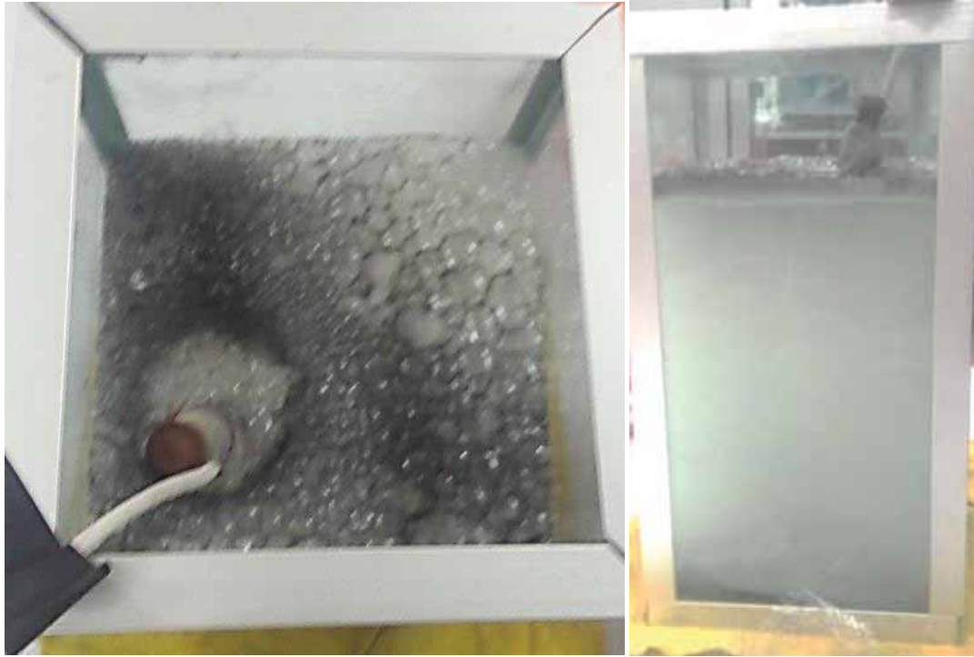
Fotografía 8. Celda de electroflotación preliminar.
