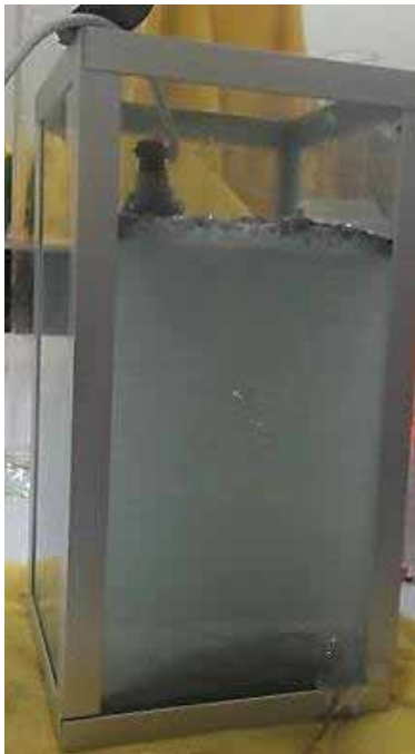
Fotografía 6. Celda de electroflotación preliminar, durante la flotación
