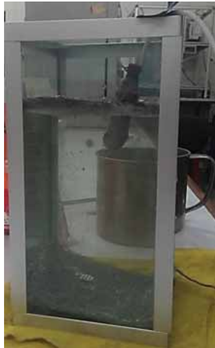
Fotografía 9. Celda de electroflotación preliminar.
