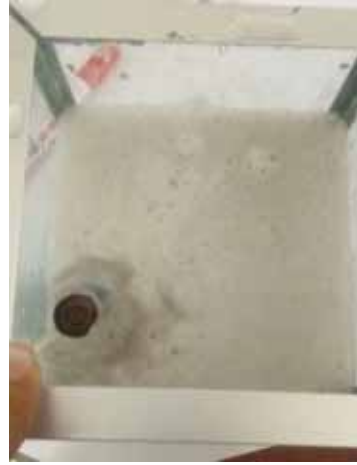
Fotografía 5. Celda de electroflotación preliminar
