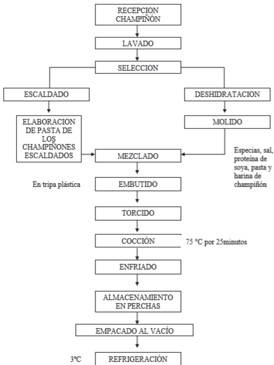
Figura 5. Diagrama de flujo embutido de champiñón. Fuente: Tipán V. Andrés y Ushiña T. Verónica. 2012.
