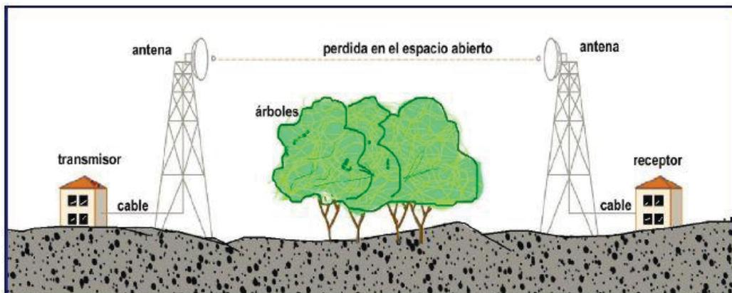
*Fig. 2.8: Enlace de microondas.*
