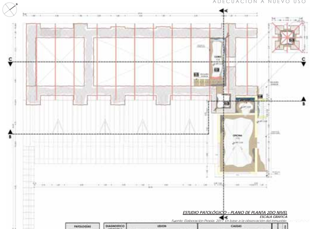
FIGURA 244. El coro presenta lesiones mecánicas y deformaciones en el entablado. Fuente: Propla, 2017
