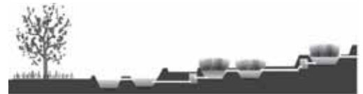
FIGURA 187: Sistema de Depuración pasiva de Aguas Residuales
