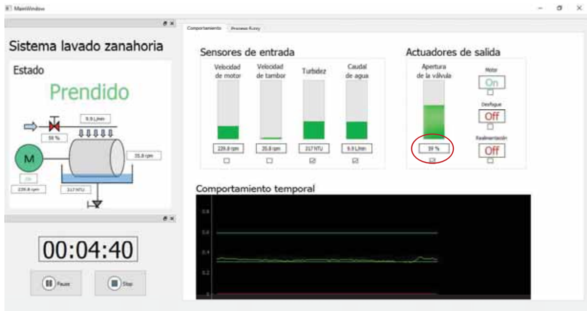
Figura 112. Resultado de la desfusificación mediante el software python Fuente: Propia
