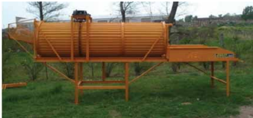
Figura 8. Proceso de lavado por aspersión y tambor
