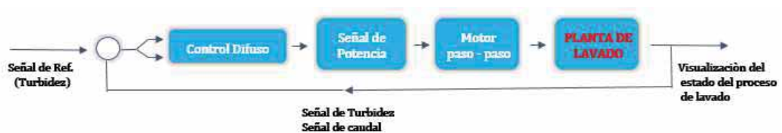
Figura 55. Diagrama general del sistema de automatización Fuente: Propia
