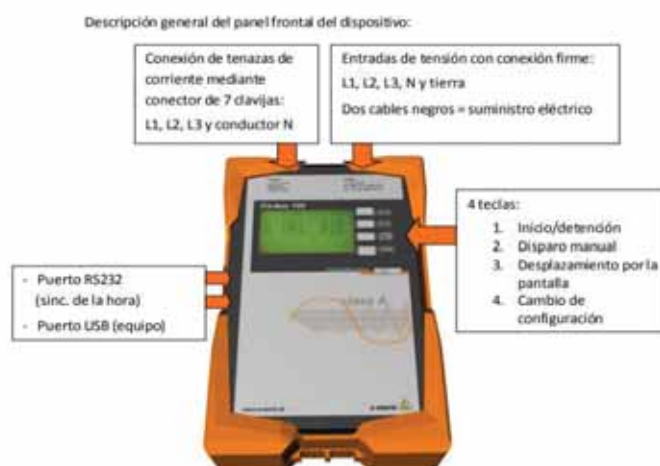
Ilustración 18 Descripción general del analizador de redes PQ-BOX100
