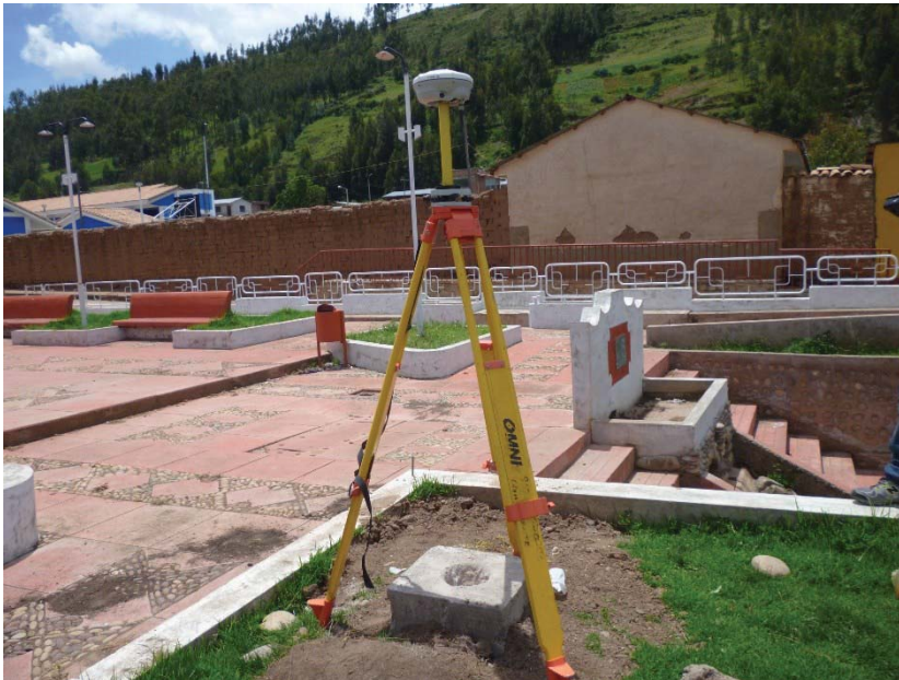
Figura 2. 2. Estación base en la plaza del distrito de Colquepata
