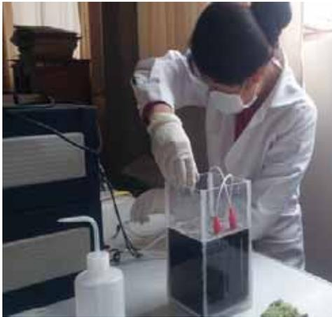
*Imagen A.16. Arranque del sistema de electrocoagulación*
