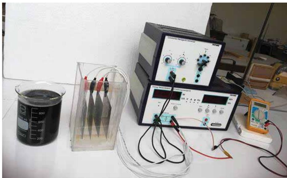
Imagen 3.1 Sistema de electrocoagulación.
