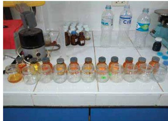
*Imagen A.25. Muestras para la obtención de la DBO<sub>5</sub>.*
