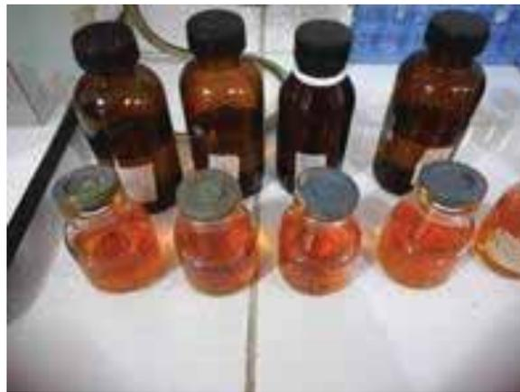
*Imagen A.26. Muestras para la obtención de la DBO<sub>5</sub> después de 5 días.*
