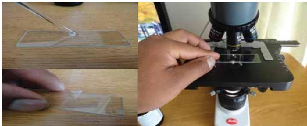
**Fotos 05:** Montado de muestra de fibra pilosa de alpaca al cubre objetos para su observación con el equipo MOTIC.
