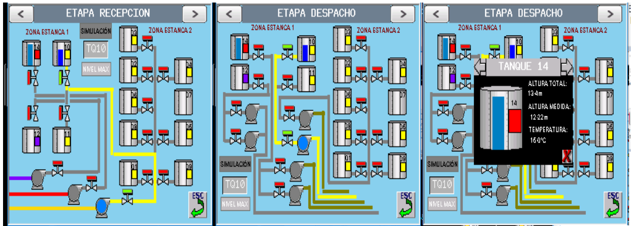
Figura 5.15 - Ventanas de las etapas de recepción, despacho con supervisión individual del almacenamiento de los tanques (Panel táctil).
