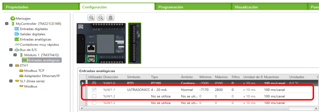
Figura 5.1 - Configuración de entradas analógicas. Fuente: Elaboración propia.
