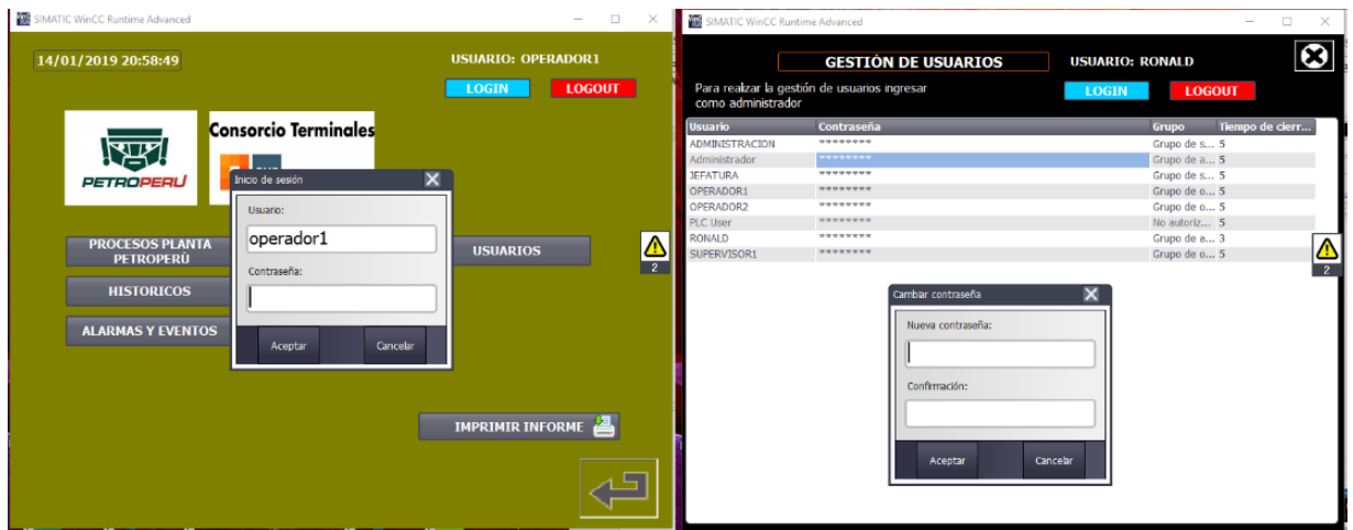
Figura 5.21 - Protección contra uso de personas no autorizadas, con niveles de seguridad. Fuente: Elaboración propia.
