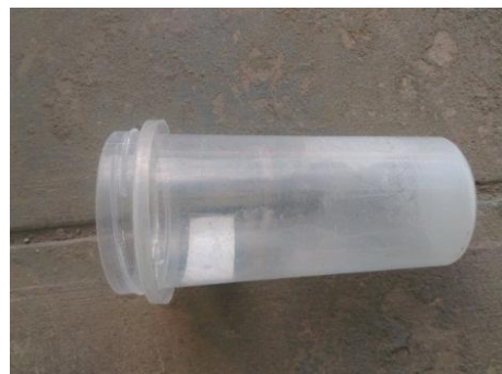
Fotografía 12. Depósito de Electrolito.
