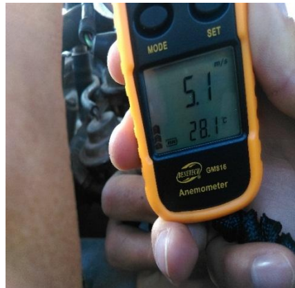
Fotografía 108. Velocidad y Temperatura de Ingreso de Aire a 2659 rpm.
