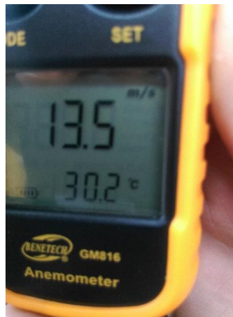
Fotografía 90. Velocidad y Temperatura de Ingreso de Aire a 2717 rpm.
