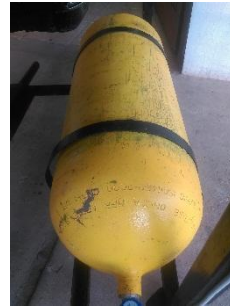
Fotografía 28. Tanque de GNV.
