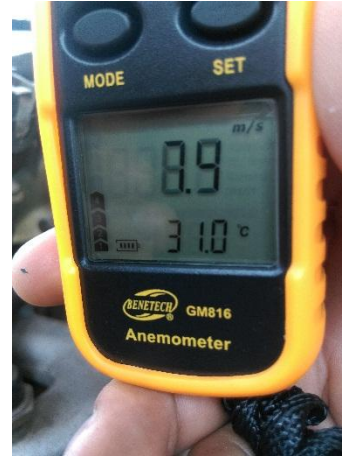
Fotografía 98. Velocidad y Temperatura de Ingreso de Aire a 2114rpm.
