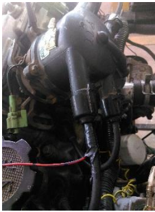
Fotografía 33. Conexión del Cable de RPM al Cable del Distribuidor del Primer Cilindro.
