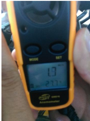
Fotografía 106. Velocidad y Temperatura de Ingreso de Aire a 953,8 rpm.
