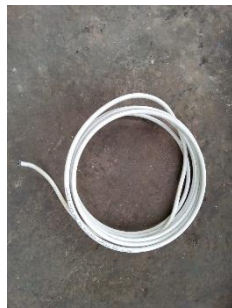
Fotografía 23. Tubería de Alta Presión (200 Bares).
