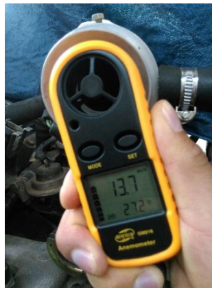
Fotografía 63. Velocidad y Temperatura de Ingreso de Aire a 2478 rpm.
