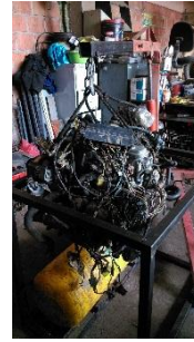
Fotografía 20. Montaje del Motor sobre la Estructura Metálica.
