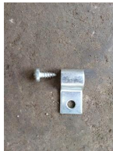
Fotografía 30. Abrazadera de la Tubería de Alta Presión.
