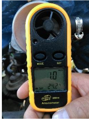
Fotografía 52. Velocidad y Temperatura de Ingreso de Aire a 760,5 rpm.
