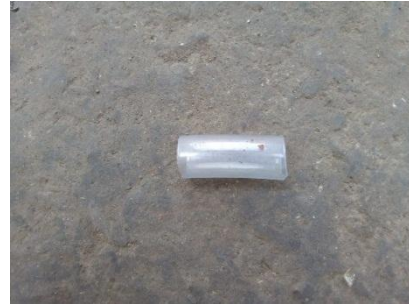
Fotografía 14. Manguera de Nivel de 1/2 pulgada.
