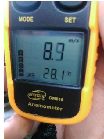
Fotografía 89. Velocidad y Temperatura de Ingreso de Aire a 1959 rpm.
