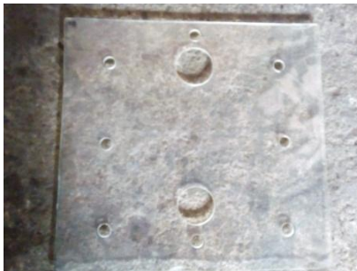
Fotografía 5. Tapa del Lado de la Salida de HHO.
