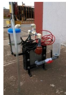
Fotografía 18. Generador de Hidrogeno.
