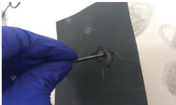
Imagen 11: Proceso de limpieza de grafito (Pulido) en lámina de Lijar (número 180).
