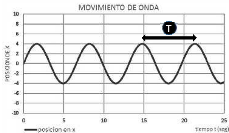
Figura 51. Representación del periodo (T) en una función senoidal.
