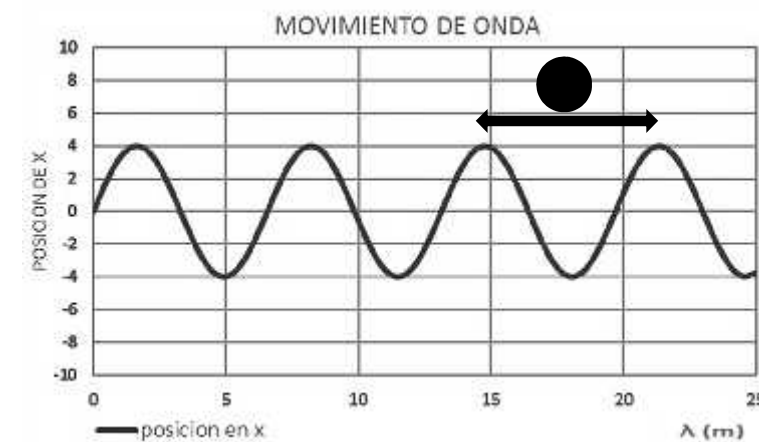
Figura 52. Representación de la longitud de onda (λ) en una función senoidal.
