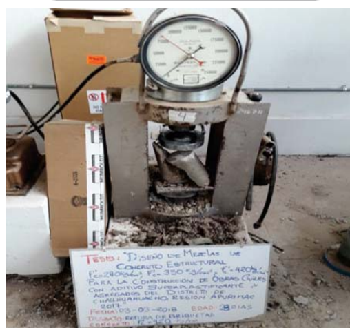
ROTURA DE BRIQUETAS DE CONCRETO F'c=280 \text{ Kg/cm}^2
