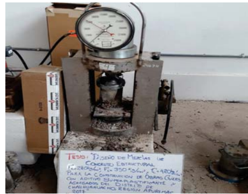
ROTURA DE BRIQUETAS DE CONCRETO F'c=280 \text{ Kg/cm}^2
