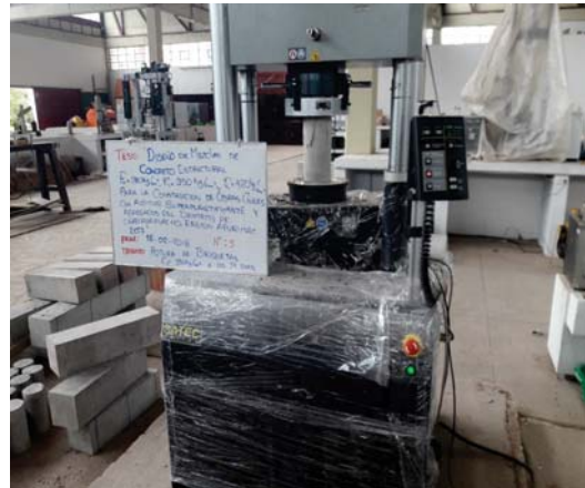
ROTURA DE BRIQUETAS DE CONCRETO PATRON F'c=280 \text{ Kg/cm}^2 .
