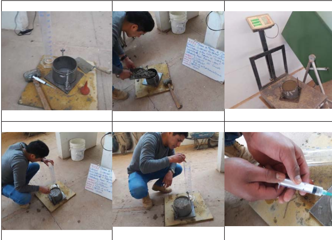
Imagen 3.19. Secuencia de actividades para el ensayo de exudación del concreto Fuente: Propia
