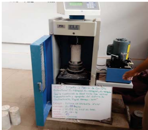
ROTURA DE BRIQUETAS DE CONCRETO F'c=420\text{ Kg/cm}^2
