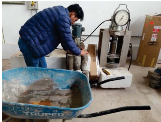
ROTURA DE BRIQUETAS DE CONCRETO F'c=420\text{ Kg/cm}^2
