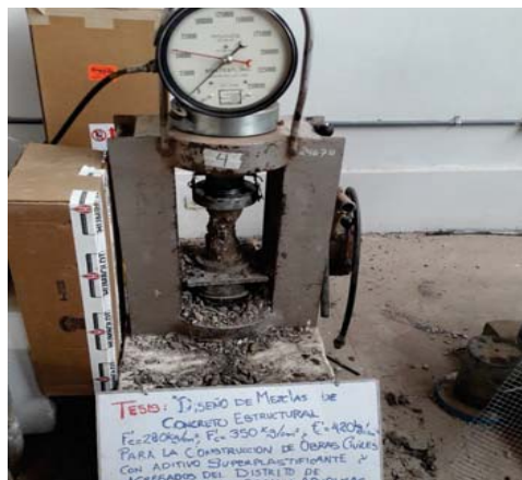
ROTURA DE BRIQUETAS DE CONCRETO F'c=280 \text{ Kg/cm}^2
