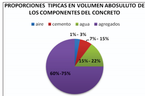
Figura 2.1. Proporciones típicas en volumen de los componentes del concreto Fuente: Perez, 2015
