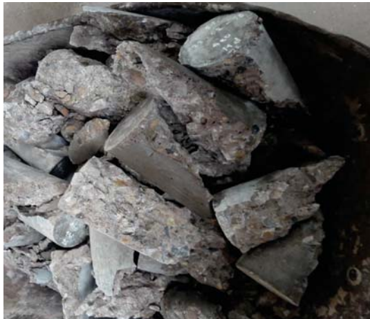
ROTURA DE BRIQUETAS DE CONCRETO f'c=350\text{ Kg/cm}^2
