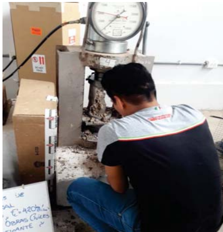
ROTURA DE BRIQUETAS DE CONCRETO f'c=350\text{ Kg/cm}^2
