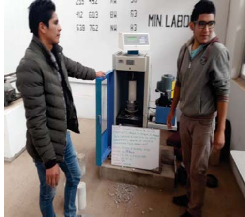
ROTURA DE BRIQUETAS DE CONCRETO F'c=280\text{ Kg/cm}^2 CON ADITIVO SUPERPLASTIFICANTE AL 0.75%.
