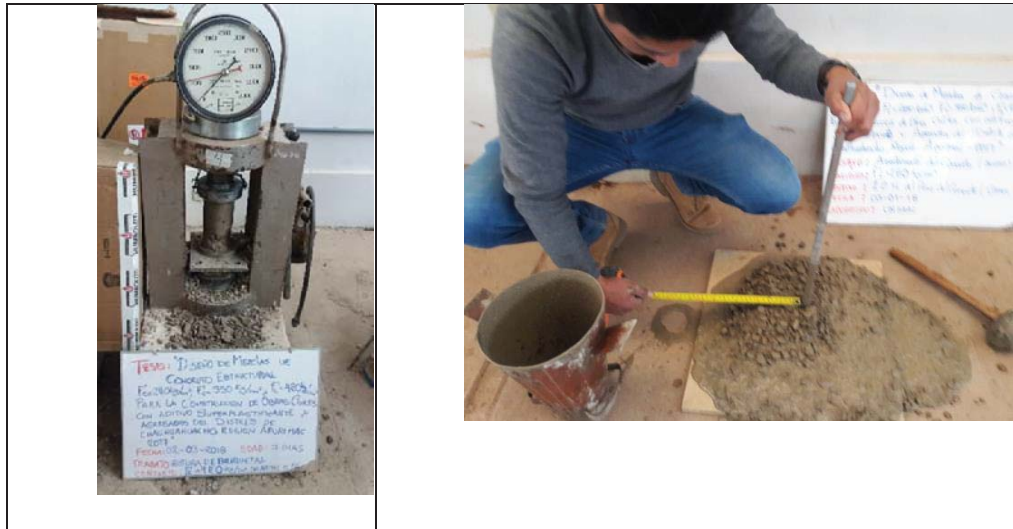
Imagen 3.5. Probetas de concreto con dosis de aditivo mayores al 1%. Fuente: Propia
