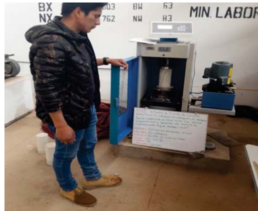
ROTURA DE BRIQUETAS DE CONCRETO F'c=350\text{ Kg/cm}^2
