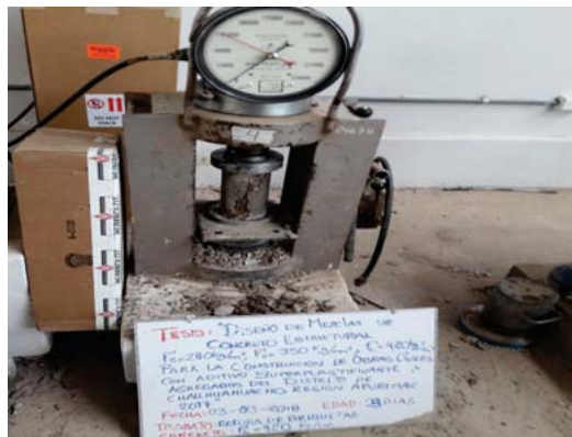
ROTURA DE BRIQUETAS DE CONCRETO F'c=350\text{ Kg/cm}^2
