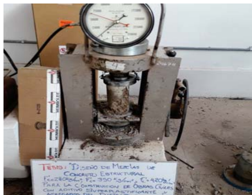
ROTURA DE BRIQUETAS DE CONCRETO F'c=350\text{ Kg/cm}^2
