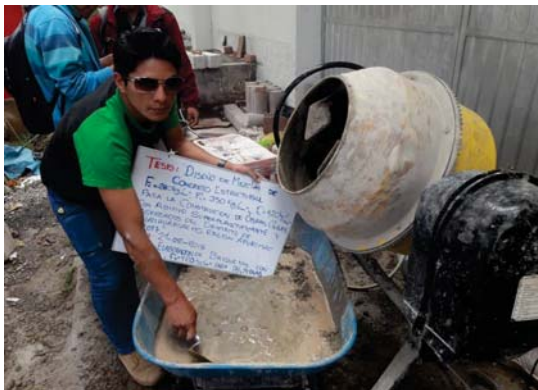
VACIADO DE BRIQUETAS DE CONCRETO F'c=350\text{ Kg/cm}^2
