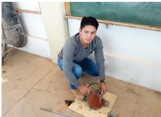
ENSAYO DE PESO UNITARIO DEL CONCRETO FRESCO.
