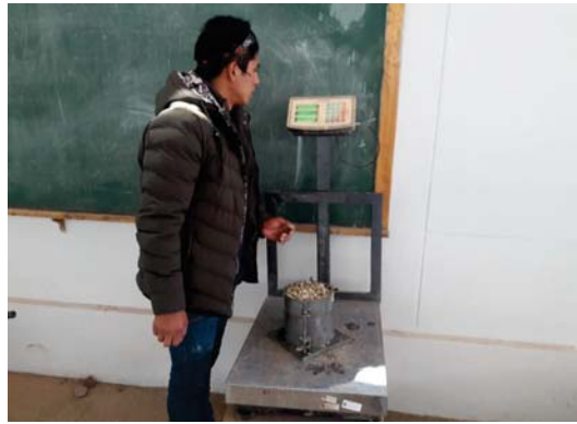
ENSAYO DE PESO UNITARIO COMPACTADO AGREGADO GRUESO
