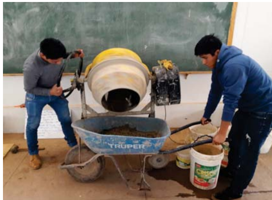
VACIADO DE BRIQUETAS DE CONCRETO F'c=420\text{ Kg/cm}^2
