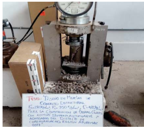
ROTURA DE BRIQUETAS DE CONCRETO f'c=420\text{ Kg/cm}^2
