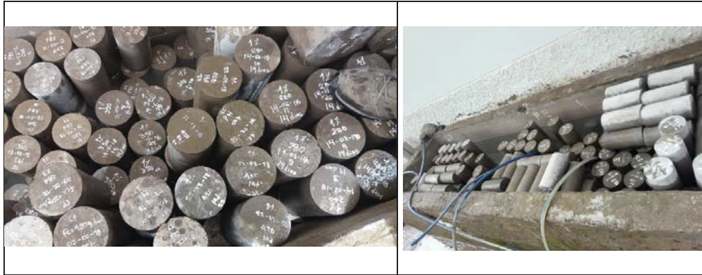
Imagen 3.20. Realizado del curado de probetas de concreto Fuente: Propia
