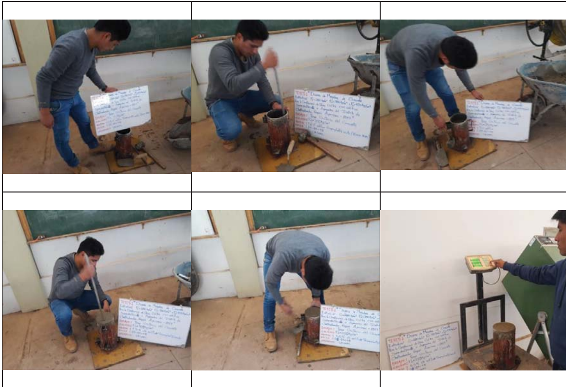
Imagen 3.18 secuencia de actividades para el ensayo de peso unitario del concreto Fuente: Propia
