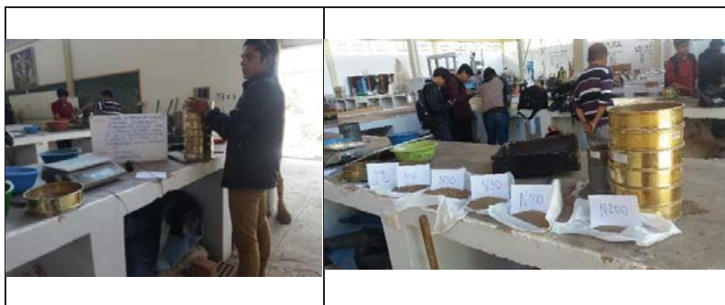
Imagen 3.11. Ensayo granulométrico de la arena fina
