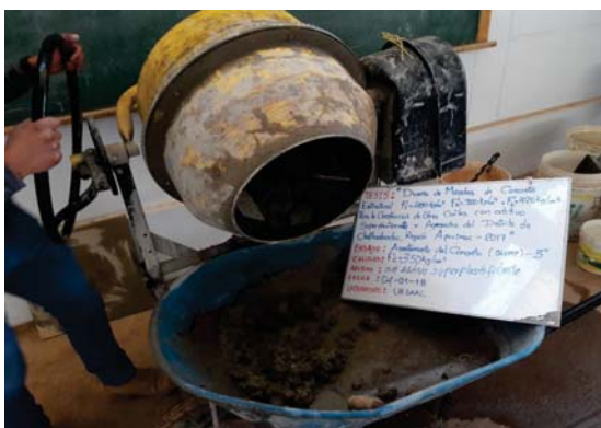
VACIADO DE BRIQUETAS DE CONCRETO f'c=420\text{ Kg/cm}^2
