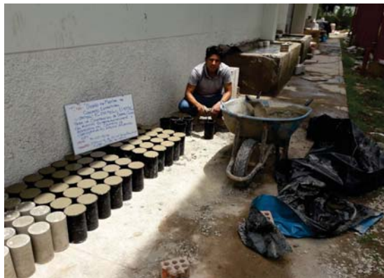
VACIADO DE BRIQUETAS DE CONCRETO f'c=350\text{ Kg/cm}^2
