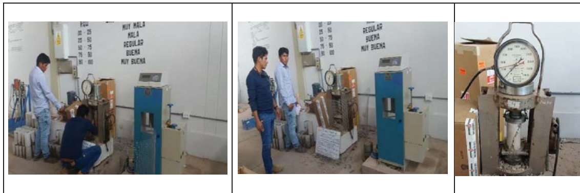
Imagen 3.21. Secuencia de la rotura de Probetas 4"x8" a compresión del concreto estructural Fuente: Propia
