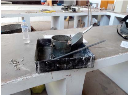
ENSAYO DE PESO UNITARIO COMPACTADO AGREGADO GRUESO
