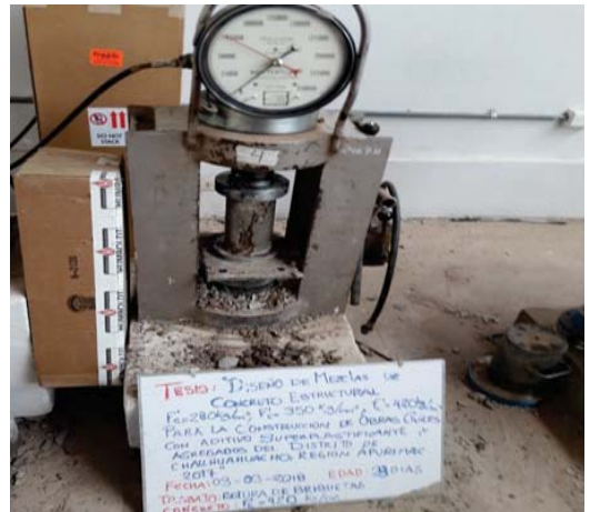
ROTURA DE BRIQUETAS DE CONCRETO f'c=350\text{ Kg/cm}^2
