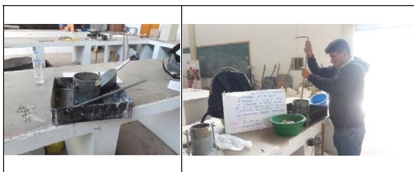
Imagen 3.10. Ensayo del peso unitario compactado de la piedra chancada
