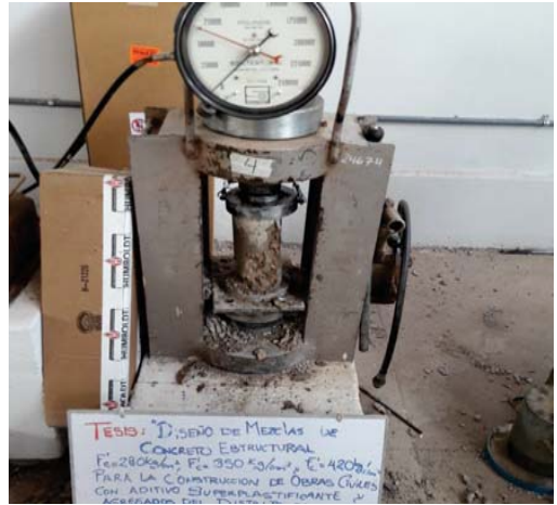
ROTURA DE BRIQUETAS DE CONCRETO f'c=350\text{ Kg/cm}^2
