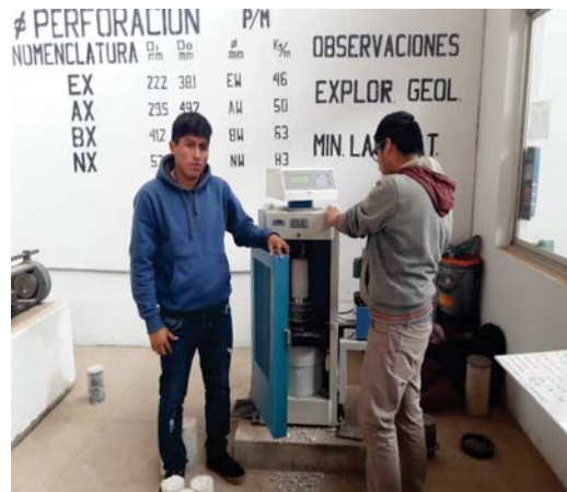
ROTURA DE BRIQUETAS DE CONCRETO F'c=420\text{ Kg/cm}^2
