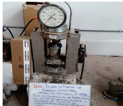
ROTURA DE BRIQUETAS DE CONCRETO F'c=280 \text{ Kg/cm}^2
