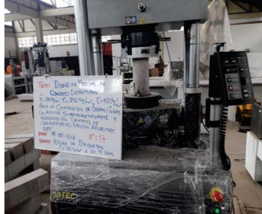
ROTURA DE BRIQUETAS DE CONCRETO PATRON F'c=420\text{ Kg/cm}^2 .
