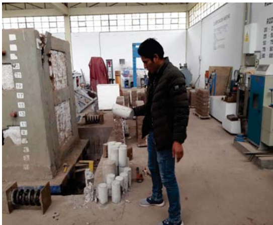
ROTURA DE BRIQUETAS DE CONCRETO f'c=420\text{ Kg/cm}^2
