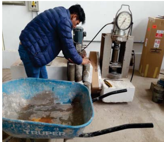
ROTURA DE BRIQUETAS DE CONCRETO f'c=420\text{ Kg/cm}^2
