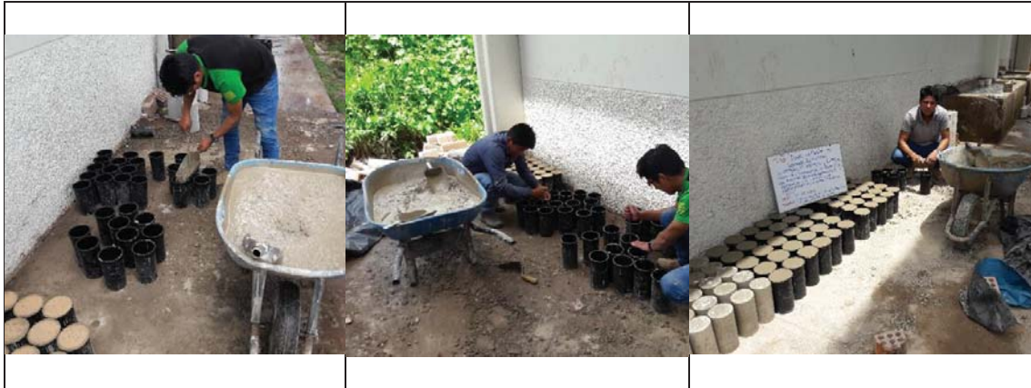
Imagen 3.16. Elaboración de especímenes de concreto Fuente: Propia
