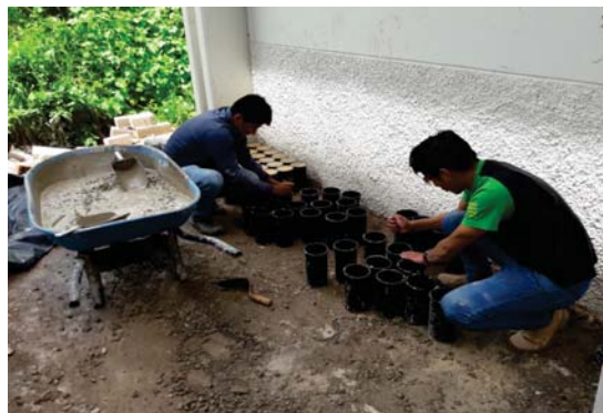
VACIADO DE BRIQUETAS DE CONCRETO F'c=420\text{ Kg/cm}^2
