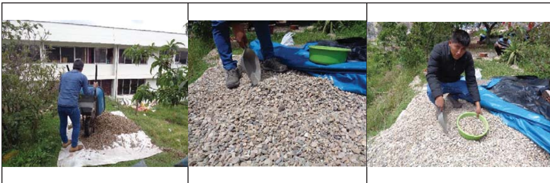
Imagen 3.6.Reducción a tamaño de prueba del agregado grueso, mediante cuarteo manual. Fuente: Propia
