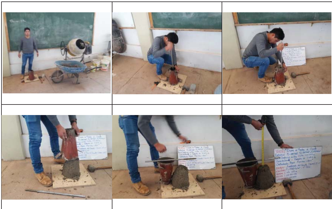
Imagen 3.17. Secuencia de actividades para el ensayo de asentamiento del concreto Fuente: Propia
