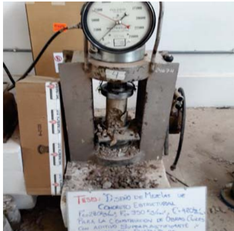
ROTURA DE BRIQUETAS DE CONCRETO f'c=420\text{ Kg/cm}^2
