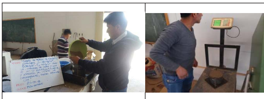
Imagen 3.9. Ensayo del peso unitario suelto en la arena Fuente: Propia
