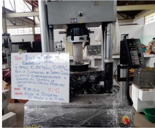
ROTURA DE BRIQUETAS DE CONCRETO PATRON F'c=350\text{ Kg/cm}^2 .
