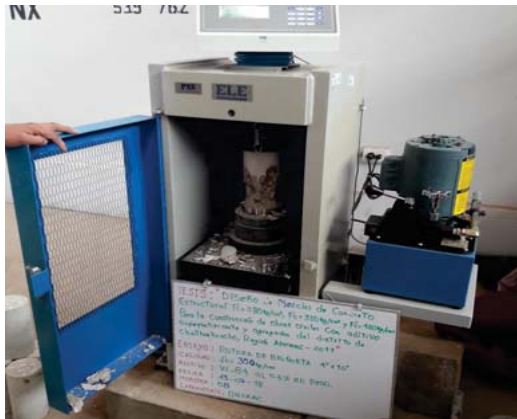
ROTURA DE BRIQUETAS DE CONCRETO F'c=350\text{ Kg/cm}^2
