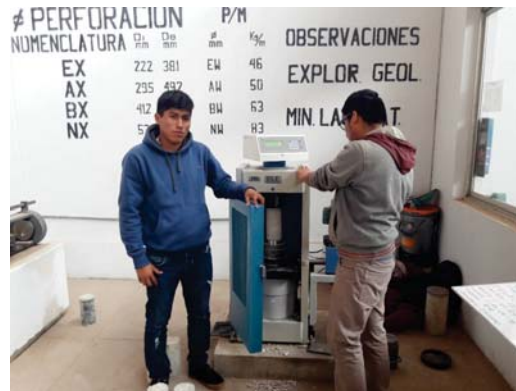
ROTURA DE BRIQUETAS DE CONCRETO f'c=420\text{ Kg/cm}^2
