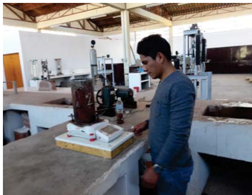
ENSAYO DE PESO UNITARIO DEL CONCRETO FRESCO.
