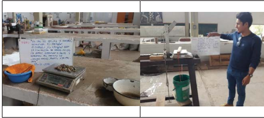
Imagen 3.8. Ensayo del peso específico y absorción de la piedra chancada Fuente: Propia
