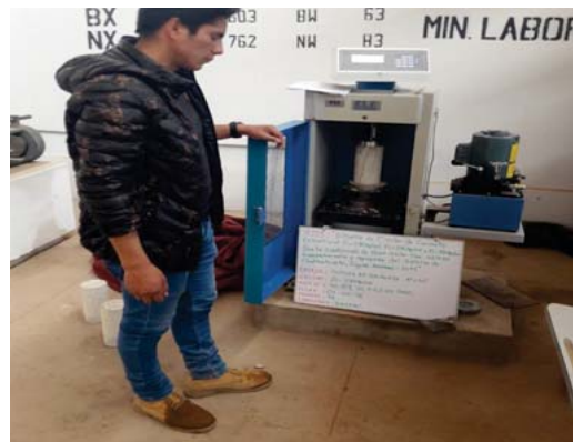
ROTURA DE BRIQUETAS DE CONCRETO f'c=350\text{ Kg/cm}^2
