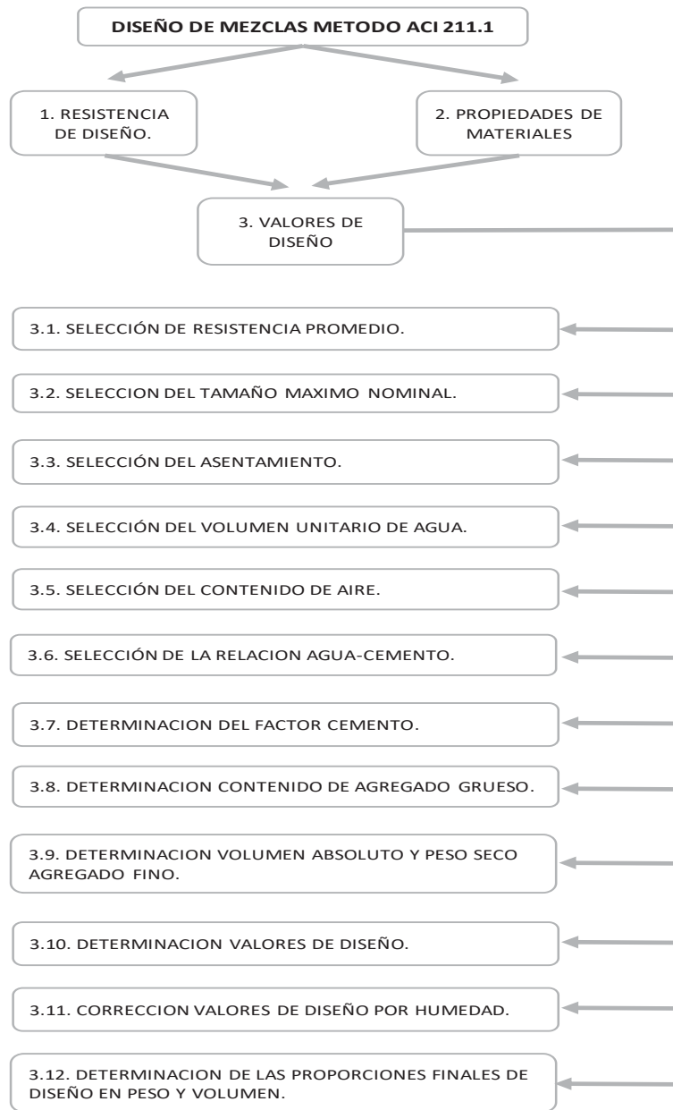
Figura 2.15. Diagrama de flujo de método ACI 211.1 Fuente:propia.
