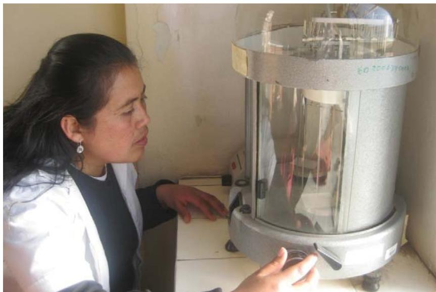
**Fotografía 18: Determinación del contenido de humedad**
