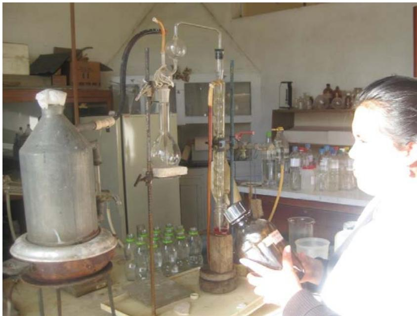
**Fotografía N° 20: Determinación del contenido de proteínas.**
