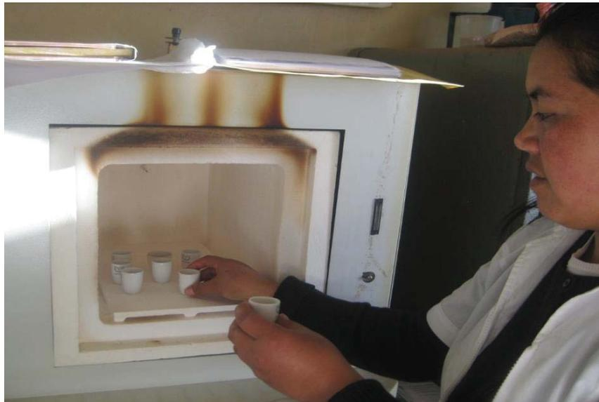
**Fotografía N° 22: Determinación del contenido de ceniza.**
