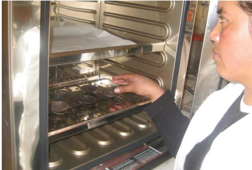
**Fotografía 19: Determinación del contenido de humedad**
