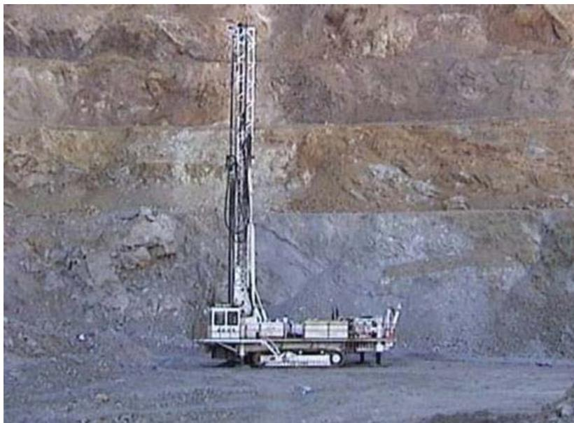
*Ilustración 12. Perforadora eléctrica B & E 49R – Diesel.*
