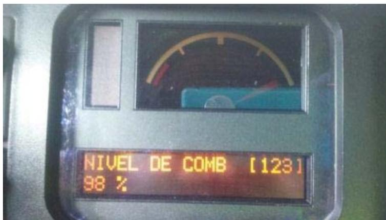
*Ilustración 70. Fotografía del medidor de combustible del camión CAT 793D.*
