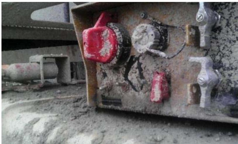
*Ilustración 54. Foto de caja de lock out dañado del camión 25.*
