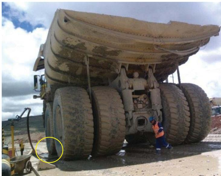
*Ilustración 55. Foto de camión en grifo sin sus respectivas cuñas.*
