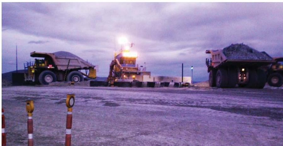
*Ilustración 36. Camión CAT 793D descargando en la Chancadora Primaria.*
