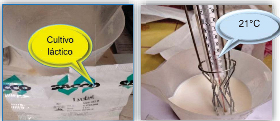
Fotografía 5. Preparación y pre activación del cultivo láctico. Fotografía 6. Temperatura de la leche 21 °C.
