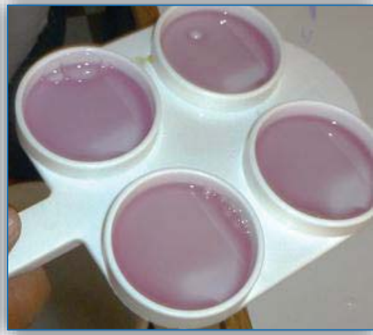
Fotografía 3. Adición del reactivo en la raqueta; Fotografía 4. Resultados de la prueba CMT (California Mastitis Test).
