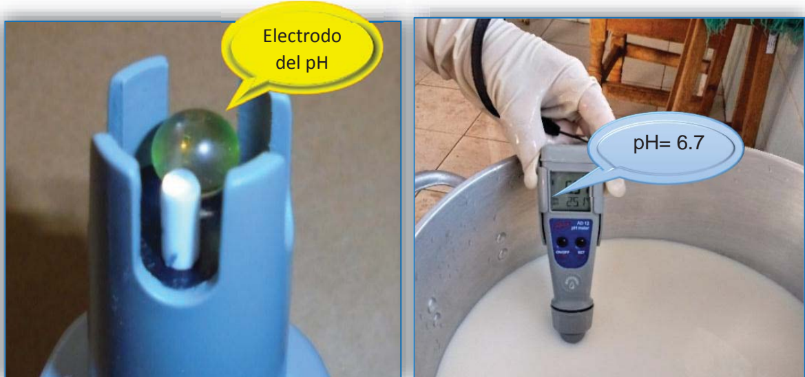
Fotografía 1. Electrodo del peachímetro; Fotografía 2. Lectura del pH inicial.
