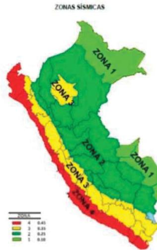
Figura 35 Zonas sísmicas del Perú.
