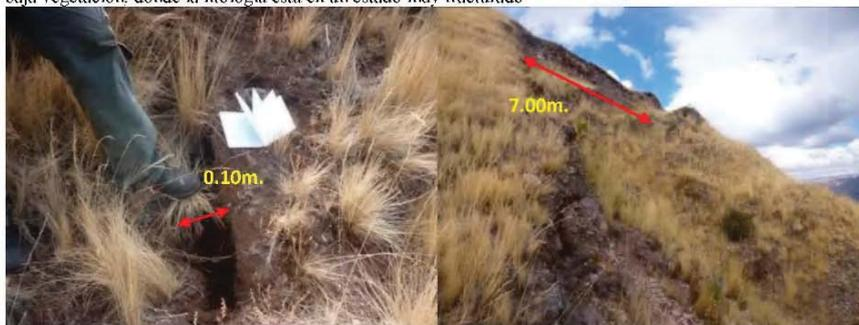
En estas imágenes se observan las grietas tensionales, ubicados en la parte superior del deslizamiento compuesto de Pícol, las aperturas de estas grietas varían de 10cm hasta 7.00m., tal como se muestra en la imagen en la derecha.
