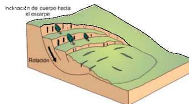
Figura 5 Esquema de deslizamiento rotacional mostrando rasgos morfológicos característicos
