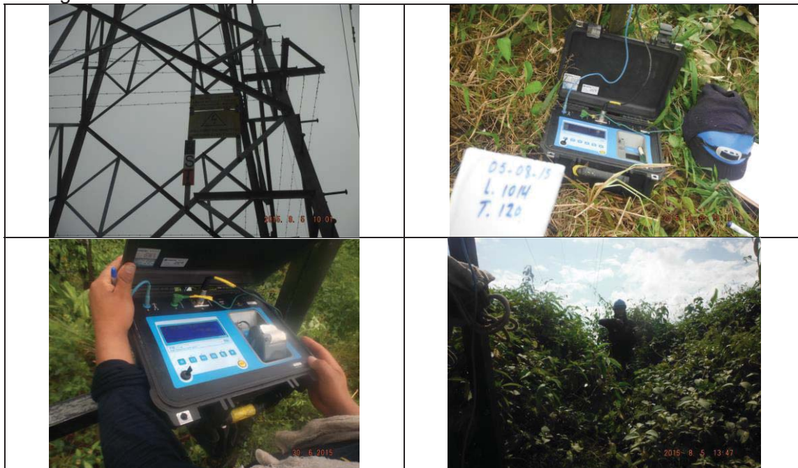
Figura N° 3. 8 Fotos representativas de la medición de resistencia en las torres.
