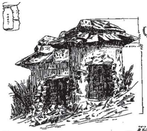
Foto N° 16: Representación de un tipo de recintos con cubierta de falsa bóveda en Paucartambo similar a los que se hallan en Machupitumarca, según (Delgado y Cáceres, 2005, p.189)
