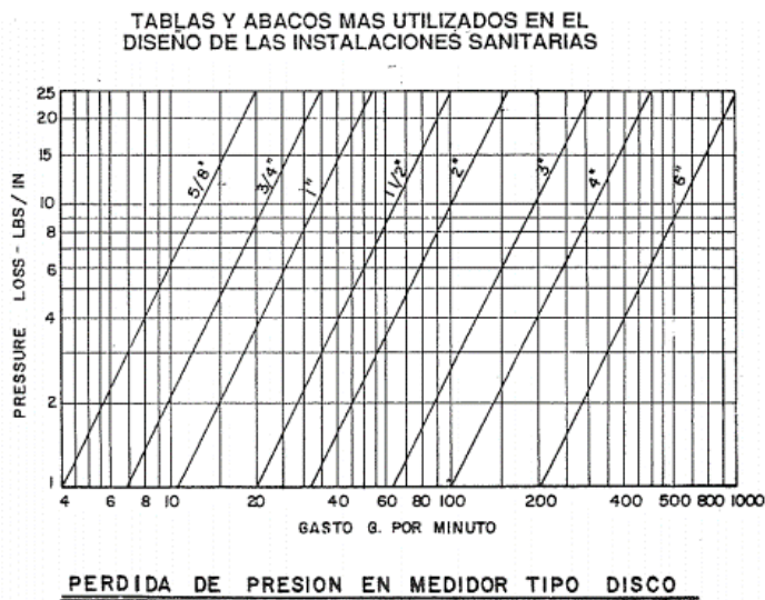
Figura 11:2 Abaco para seleccionar el medidor
