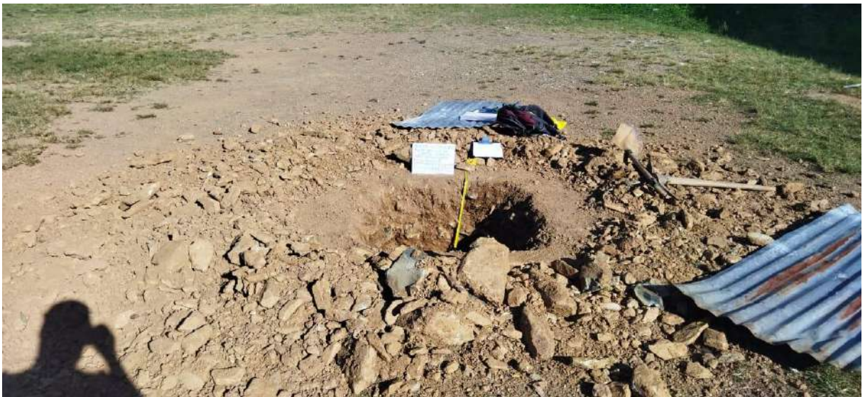
Foto N°12: calicata en la progresiva (02+0000) observándose estrato de una sola capa suelo muy duro de poca humedad y con conglomerados de diámetro de 10 a 20 centímetros, Fuente: Propia
