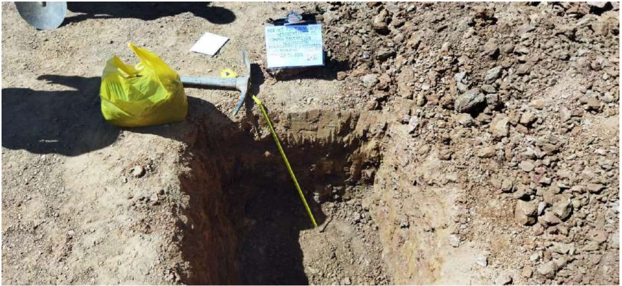
Foto N°11: suelo moderadamente suave compuesto por arenisca rojiza con clastos de 5cm con poca humedad. Fuente: Propia
