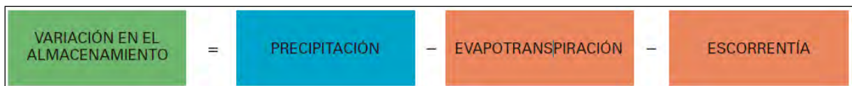
Figura 6 Balance hidrológico en una cuenca cerrada para un intervalo de tiempo determinado. Ley de conservación de la masa.
