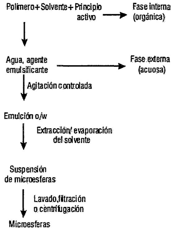
**Figura 6.** Preparación del Método de Evaporación/Extracción del Solvente en Fase Acuosa O/W.
