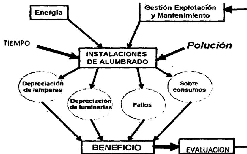
Fig. 1-2: Esquema de la problemática de las instalaciones de alumbrado público considerando la evaluación y actuación posible.
