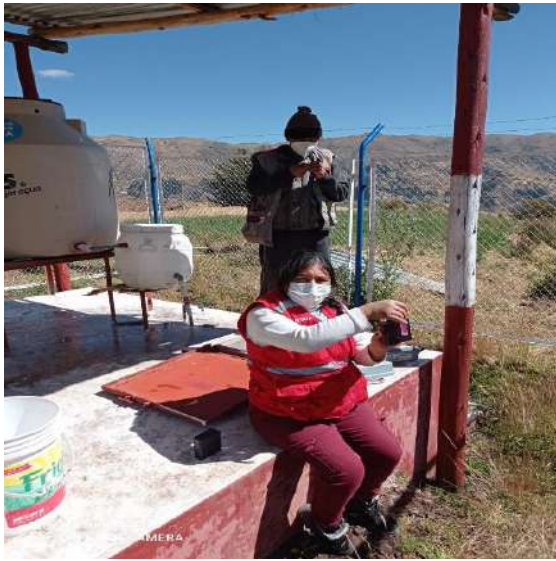
FOTO 23: monitoreo de cloro residual en el reservorio.
