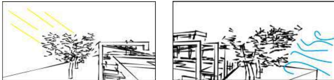
Imagen N°24. Vegetación como regulador de la radiación y como barrera frente al viento Fuente: Elaboración propia
